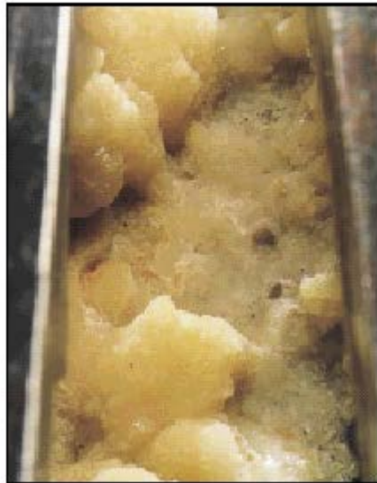
Fig.11.- Eliminación de incrustaciones de carbonato de calcio con chorro de agua. La tubería de producción recibió un solo chorro de agua a razón de 2,4 pulg./min (1 mm/seg). Si bien se ha logrado remover los sedimentos de carbonatos todavía se observa una cantidad remanente considerable.
