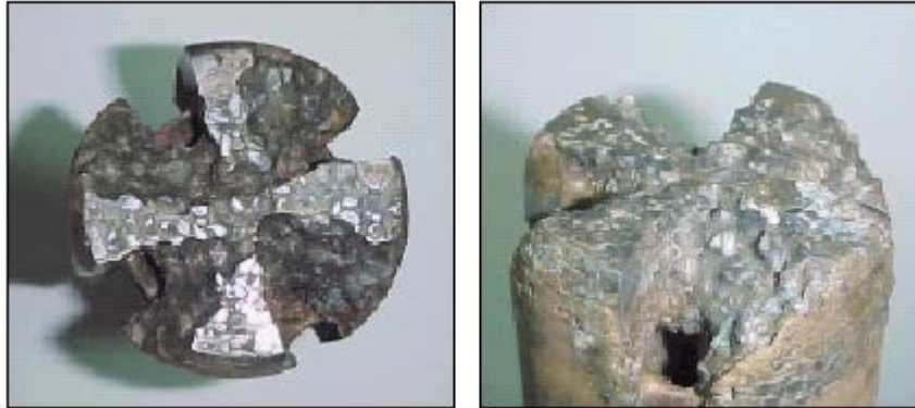
Fig.19 .- Cabeza pulidora gastada por el polvo de sílice.
