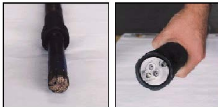
Fig.18.- Cabeza fresadora Bridge Blaster. El sistema Bridge Blaster se puede configurar con una cabeza expulsora radial, un anillo flotante y una fresa Reed-Hycalog (izquierda), o bien con boquillas de chorro abrasivo orientadas hacia abajo (derecha), que perforan un hoyo en los puentes de incrustaciones que no se pueden cortar con una fresa de carburo de tungsteno.
