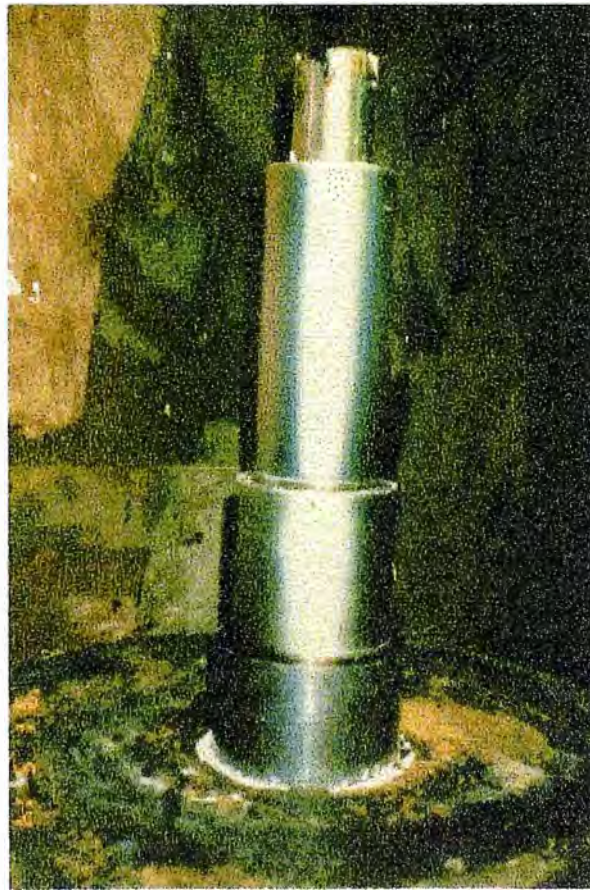
Árbol central de un motor de turbina de vapor, de la industria azucarera Longitud: 50 plg. Diámetro: 8 plg.
