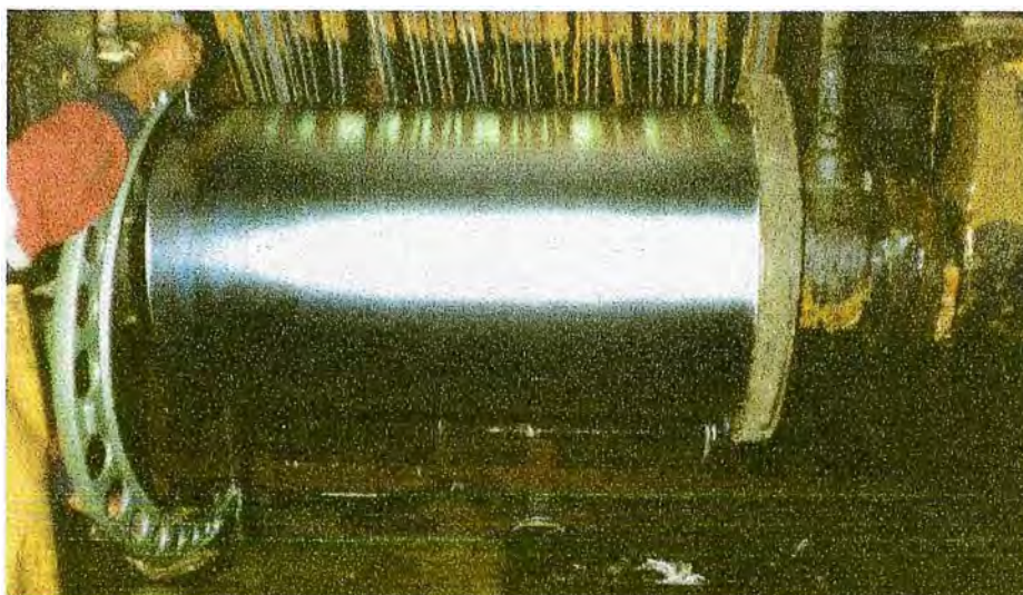
Rodillo de imprenta Longitud: 50 plg. Diámetro: 10 plg.
