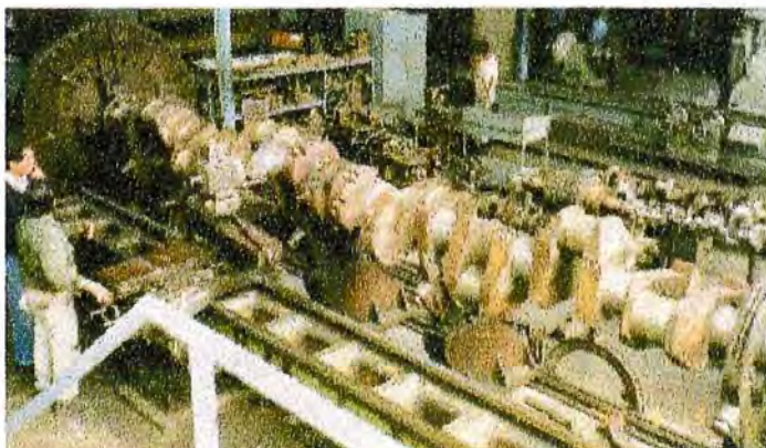
Cigüeñal de motor naval Longitud: 6 m
