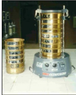
Figura 3.1: Tamices Tyler y equipo vibrador de tamices Laboratorio de pulpas de PSI – Referencia 14
