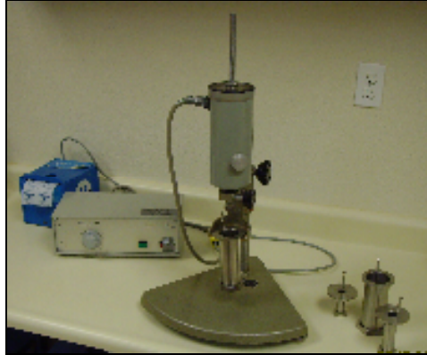
Figura 3.3: Viscosímetro con diferentes tazas y péndulos Laboratorio de pulpas de PSI – Referencia 14
