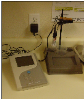
Figura 3.4: Equipo para el ensayo de corrosión de una pulpa Laboratorio de pulpas de PSI – Referencia 14
