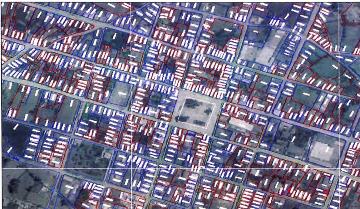
Figura 6.19 Sobreposición que muestra la distorsión geométrica de la aerofotografía
