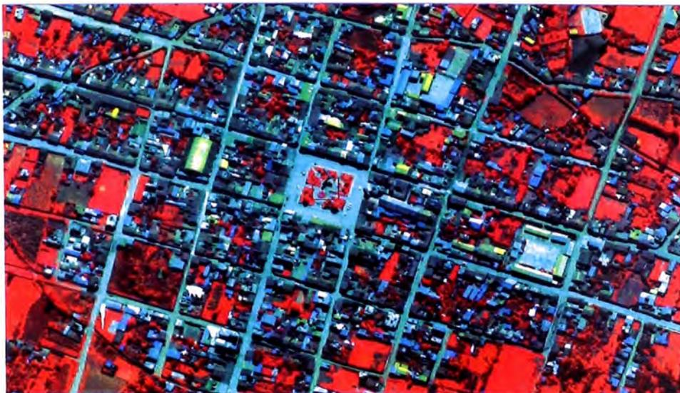
La obtención de área de cobertura vegetal, se consigue mediante la relación que existe con el número de píxeles de la imagen. Que es discriminada mediante operaciones hechas, con parámetros fijados según el NDVI correspondiente a cobertura vegetal. Permitiendo de esta forma la obtención del número de píxel de vegetación. Que en el presente caso asciende a 462.724 píxeles, que se reportan en el cuadro inferior.
