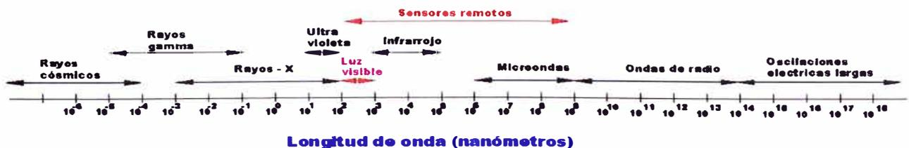
Figura 8.8 Espectro electromagnético y alcance actual de los sensores remotos
