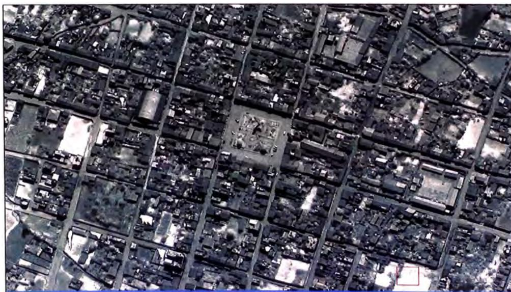
**Figura 8.21.B** Representación gráfica de la banda 4 en el cálculo del NDVI en escalas de grises
