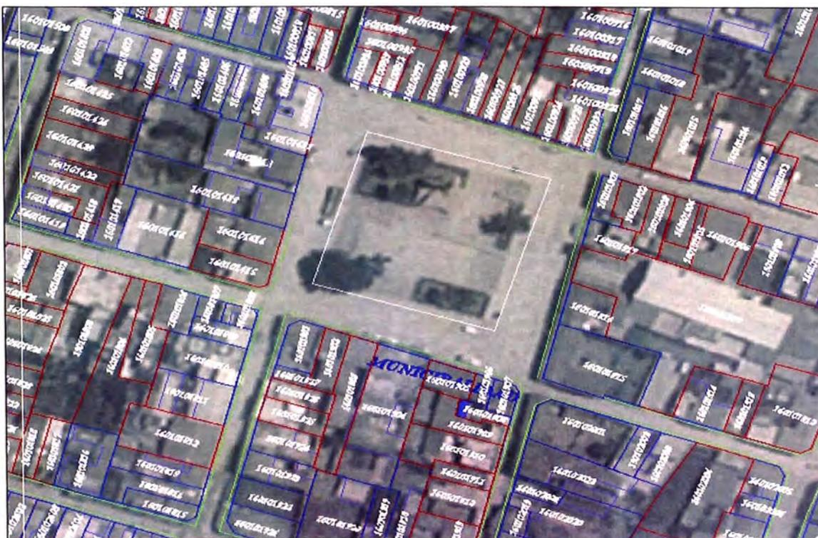
Figura 6.20 La distorsión de la aerofotografía se muestra más notoria en la zona de sombra de manzanas
