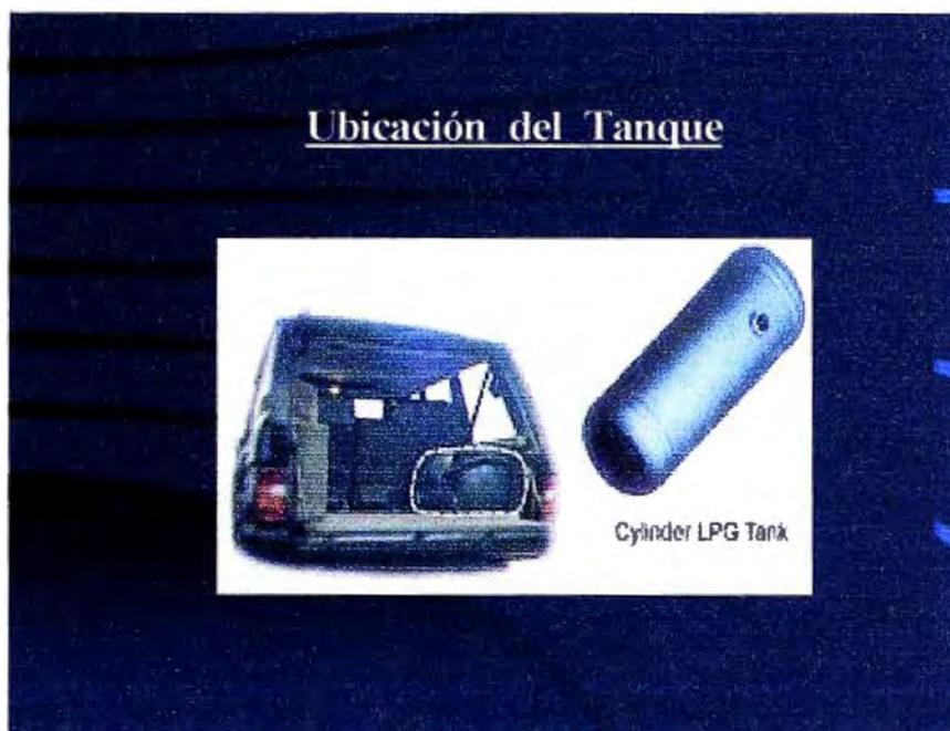
El depósito de GLP debe estar construido en chapa de acero, la cual debe ser de tales características que la presión correspondiente al límite de elasticidad no sea inferior a  $40 \text{ kg/cm}^2$ .
