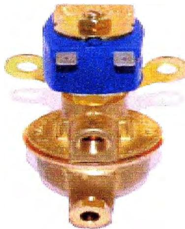
La bobina que es de 12 V, está construida con espiras de hilo de cobre esmaltado enrolladas sobre un carrete de zytel, provista de un yugo de acero, de 4 mm de espesor y encapsulada toda ella en plástico negro.
