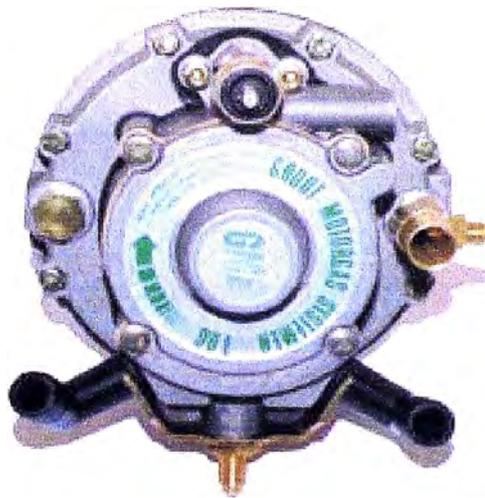
Para ello este aparato dispone de dos cámaras, una de reducción de presión, la cual hace a su vez la función de intercambiador de calor y otra de dosificación del gas. La presión máxima de alimentación del GLP, en estado líquido, al evaporador – regulador, es de 30 kg/cm<sup>2</sup>.
