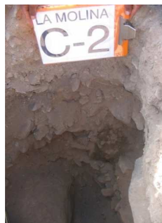
Foto 2.6 : Grava de origen coluvial, perfil del terreno sector Rincón de La Planicie en La Molina (vista anterior), se observa la típica forma subangulosa debido al escaso transporte.
