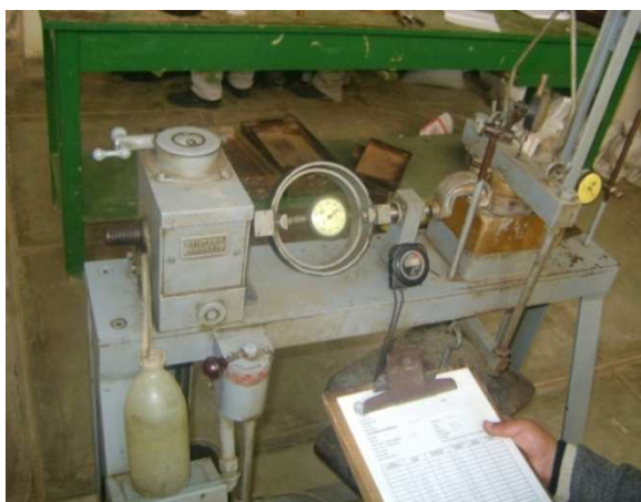
FOTO 8.3 Equipo de corte directo con sistema de aplicación de esfuerzos horizontal y normal.
