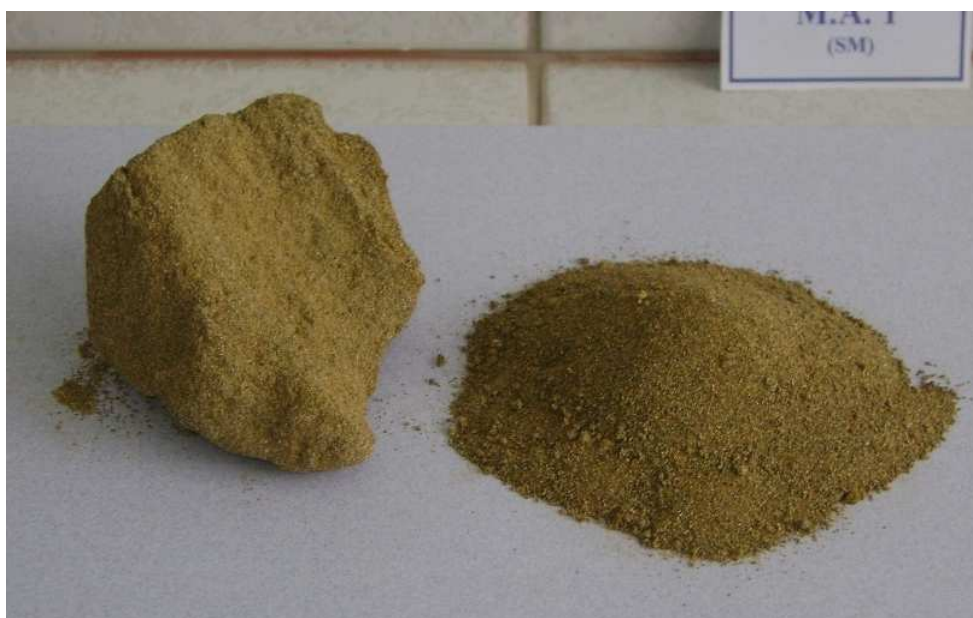
FOTO 8.11 Arena limosa M.A.1, trozo inalterado y material disturbado.
