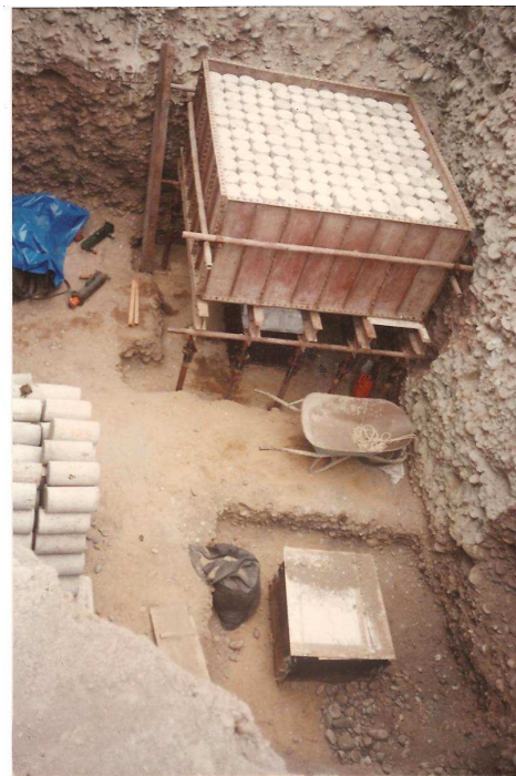
Foto 6.8 Sistema de aplicación de la carga normal, mediante un cajón metálico lleno con probetas de concreto. Se aprecia dos especímenes.
