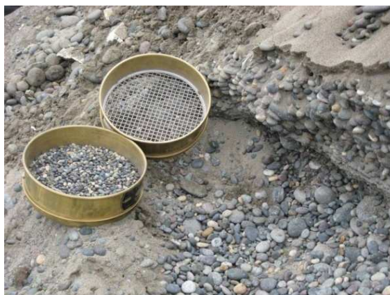
FOTO 7.9 Tamizado "in situ" de la grava y obtención de muestra de tamaño seleccionado para los ensayos de corte.
