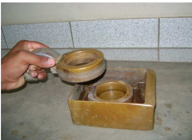
FOTO 8.1 Caja de corte con detalle de las partes fija y móvil.
