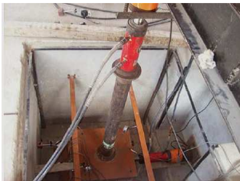
Foto 3.1: Equipo de corte directo para suelos gravosos del laboratorio Geotécnico CISMID-UNI.
