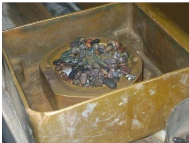
FOTO 8.18 Especimen ensayado, se observa la mezcla saturada de grava y matriz arenosa M.A.2.
