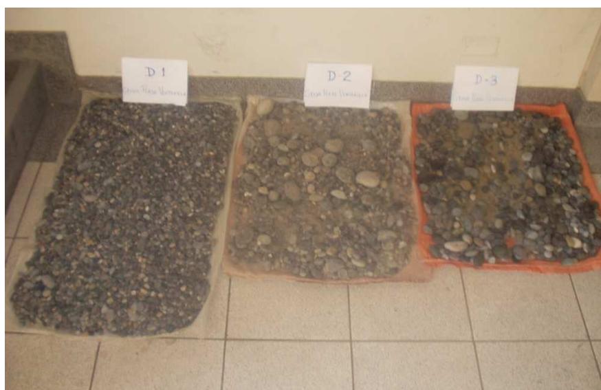
FOTO 7.22 Vista de las tres muestras en conjunto, la muestra D-1 presento mayor densidad, seguida de la muestra D-2, la muestra D-3 fue la más suelta. La variación de densidades se debe a su granulometría.
