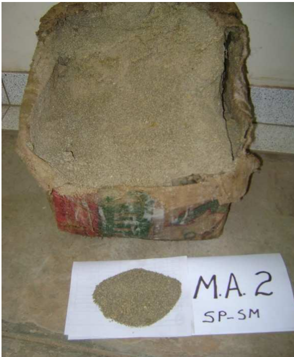
FOTO 8.14 Bloque inalterado de arena limosa pobremente gradada (SP-SM) usada como matriz M.A.2
