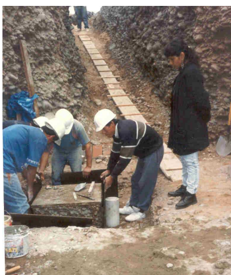
Foto 6.3 Verificación de dimensiones del espécimen, de acuerdo a las planchas de confinamiento.
