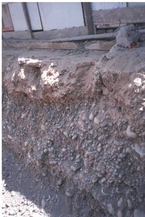
Foto 2.1: Depósito aluvial formado por el río Rímac, perfil ubicado en el distrito de Jesús María.
