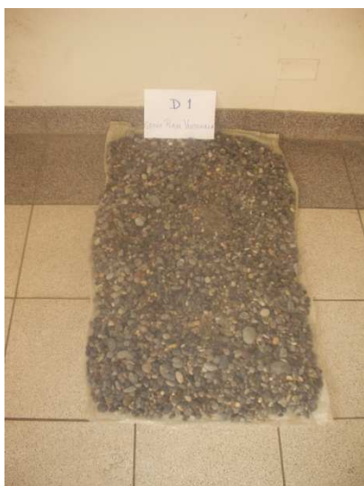
FOTO 7.19 Muestra de la prueba de densidad D-1, con mayor matriz y granulometría continua.
