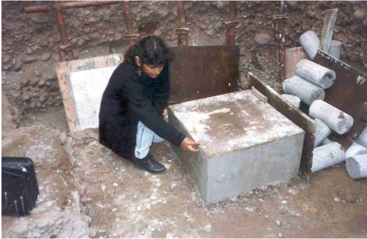
Foto 6.4 Alisado de las caras de la muestra con lechada de cemento
