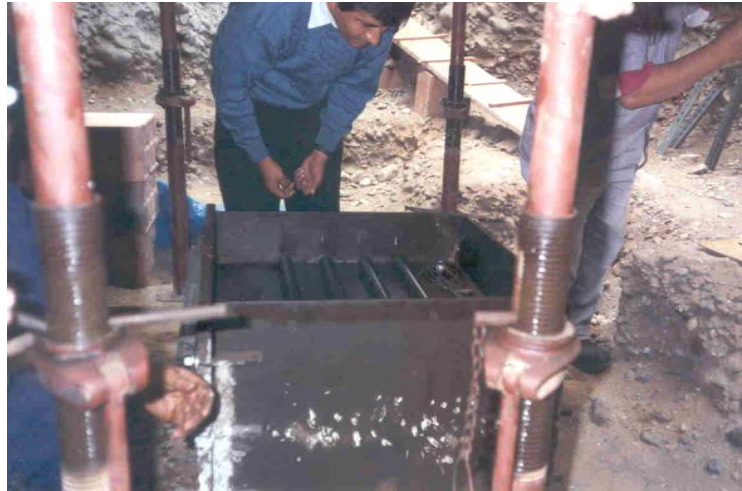
Foto 6.7 Colocación de polines sobre la cara superior de la muestra, su función es evitar que el sistema se desestabilice con el esfuerzo normal.
