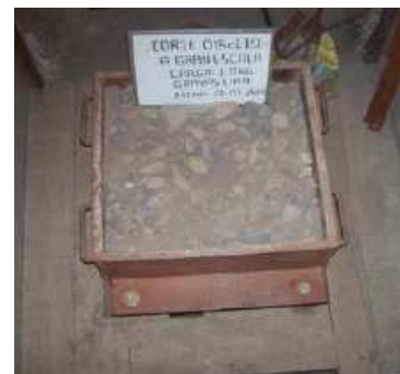
Foto 3.2: Caja de corte de 0.60m.x0.60x0.60m. para especímenes de 4 pulgadas
