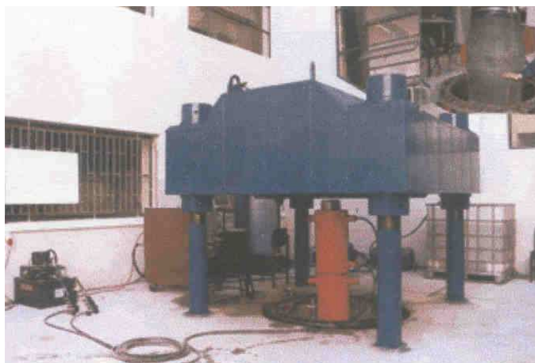
Foto 3.8 : Equipo triaxial gigante de la IDIEM, Chile.
