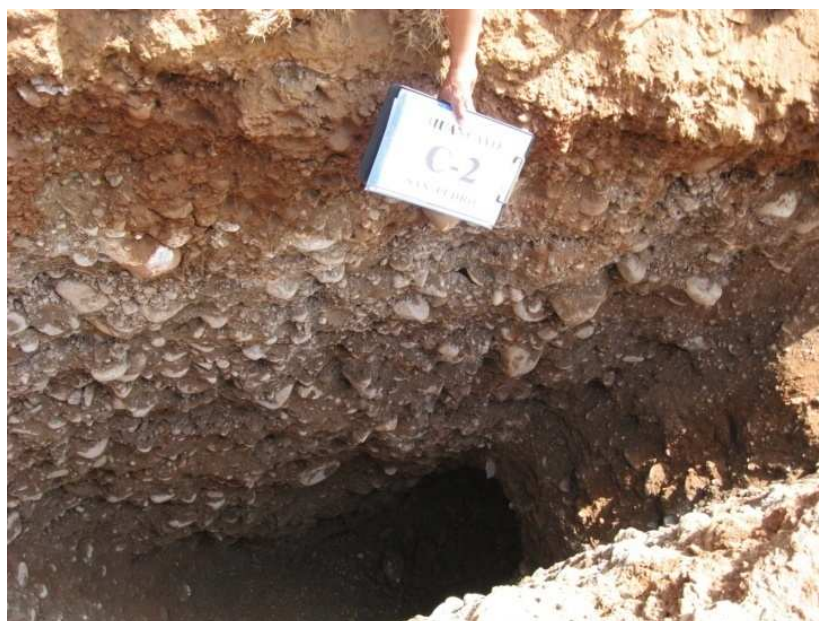
Foto 2.3: Depósito aluvial de Huancayo, perfil ubicado en el sector de El Tambo. En dicho lugar se registran gravas con matriz arcillosa (GW-GC y GP-GC) de buena compacidad.
