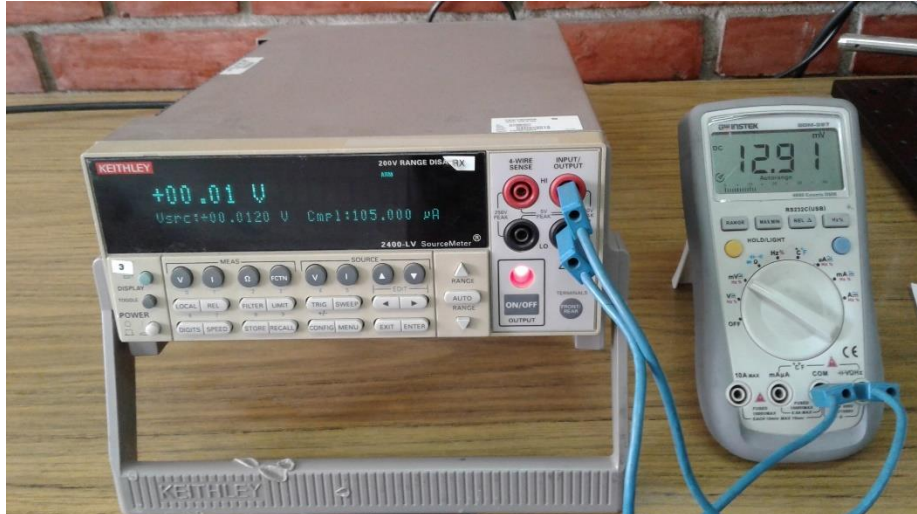
Figura A.6: Verificación de multímetro usado en la medición de irradiancia
