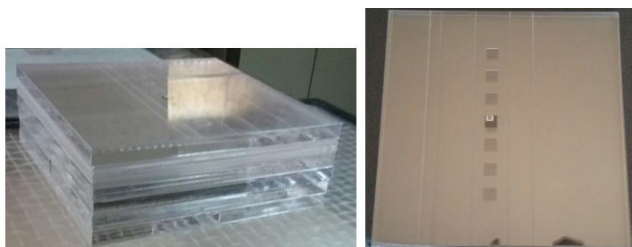
Figura 35: Fantoma de PPMA para la caracterización de OSL nano dot en el linac, parte 2.
