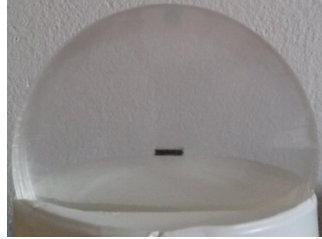
Figura 36: Fantoma circular de PPMA para la caracterización de la dependencia angular de OSL nano dot en el linac.
