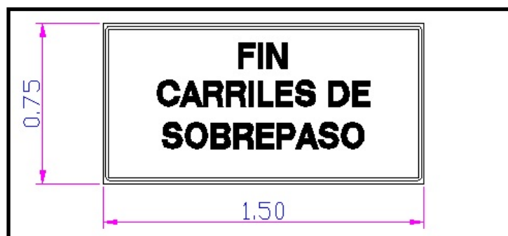
Fig 5.6.1.9. Aviso de finalización de la zona de los carriles de sobrepaso.
