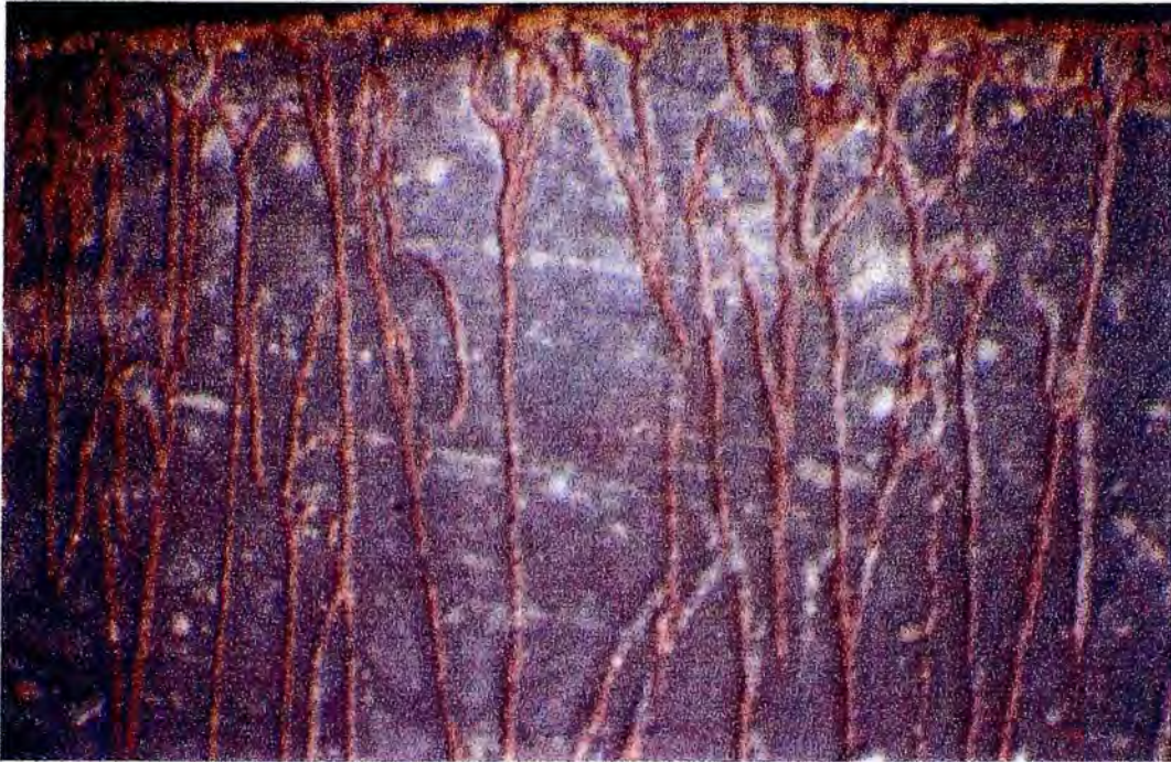
FOTO 34: Pb-0.2%Ca, probeta anterior, se aprecian las líneas interdendríticas atacadas atacadas fuertemente por la solución ácida y densidad de corriente (30 mA/cm 2 ).
