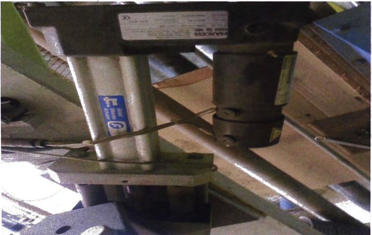
Figura 1.2 Accionamiento de Cilindro Neumático mediante Servo – Motor de un alineador de papel
