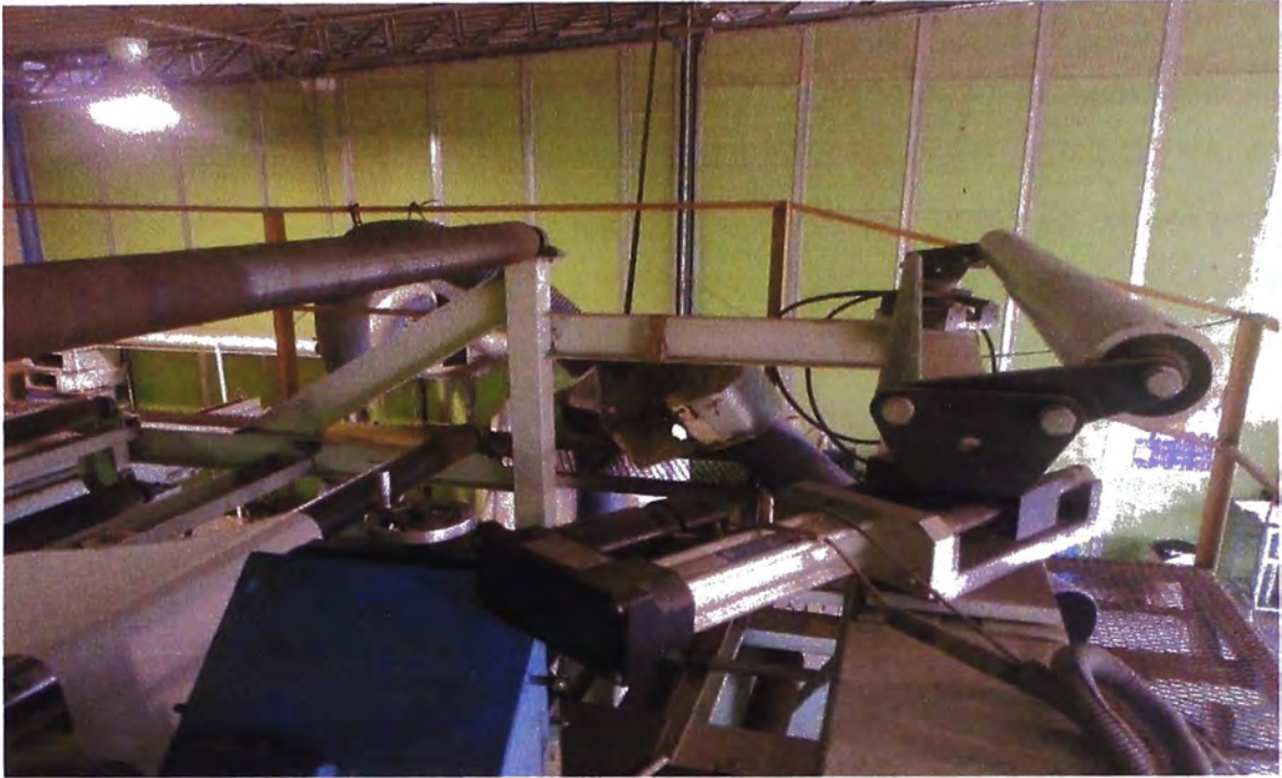
Figura 1.3 Alineador de papel con aplicación de rodillo y control neumático por Servo – Motor.
