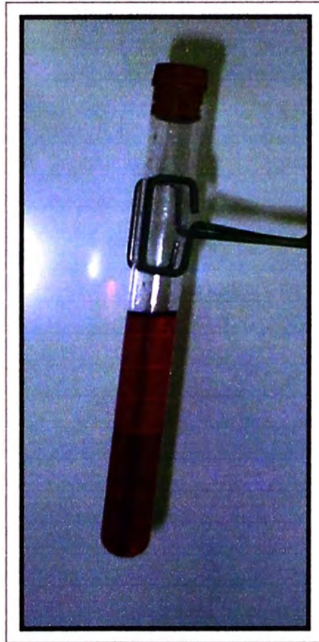
Fig. 2.20. Fase amílica (superior) ligeramente ácida y fase acuosa (inferior) acidificada con HCl.
