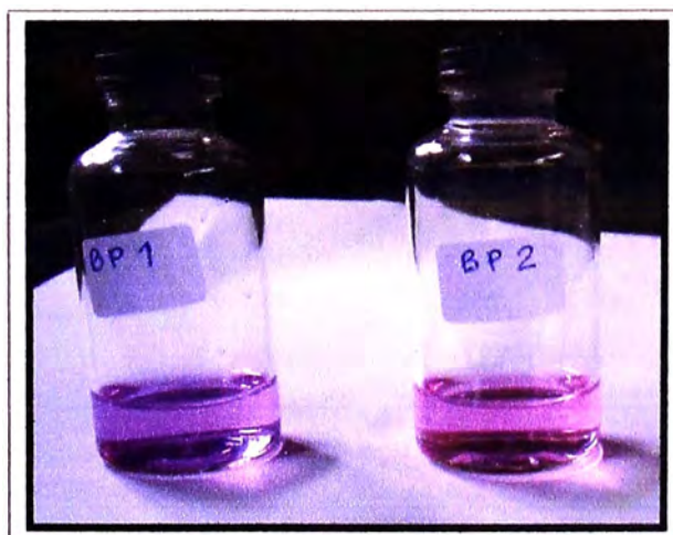
Fig. 2.30. Eluentes de la banda 1 y 2, después de cortar las bandas del papel y sumergirlos en Metanol puro.
