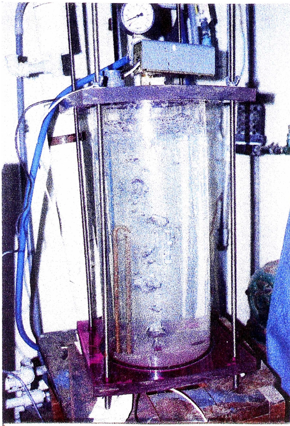
Figura N° 2 Burbujas producidas en la columna a P = 10 psi.
