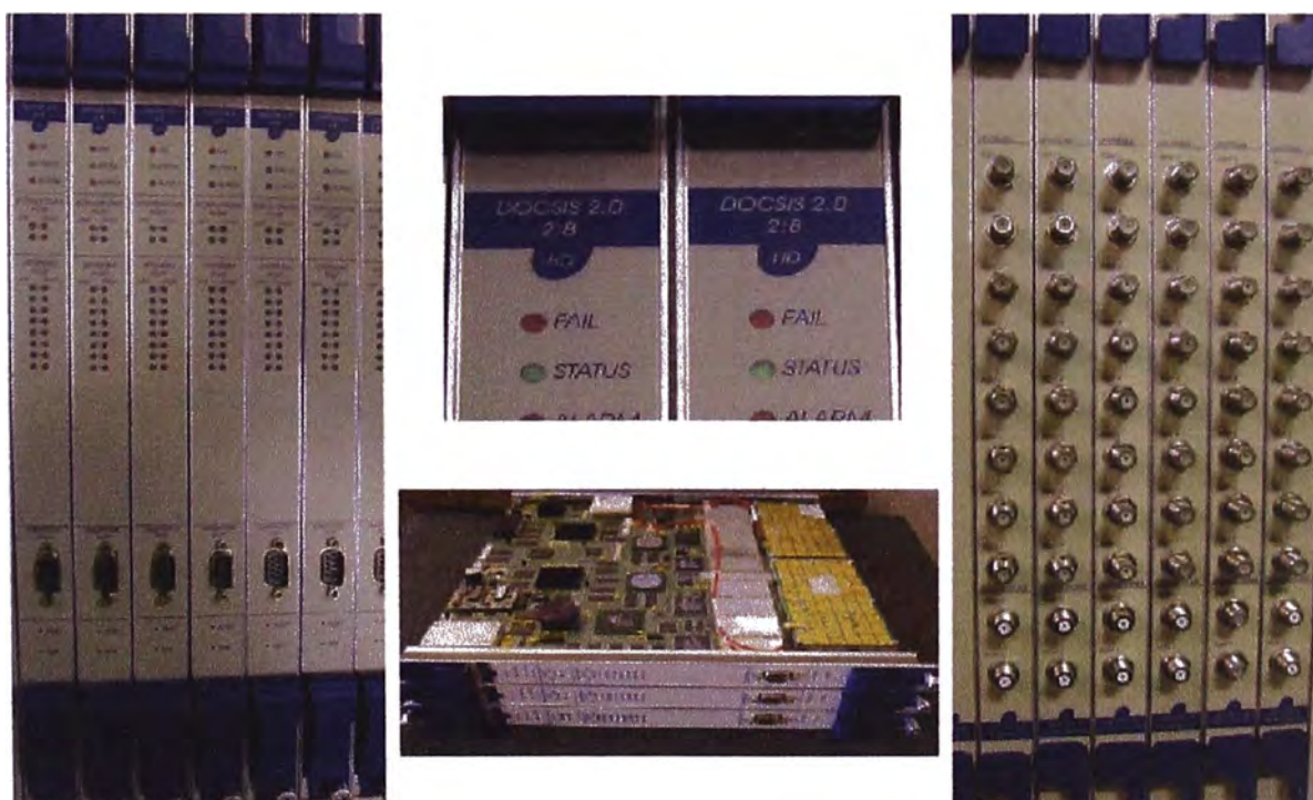
Figura 8.2 Vista frontal y posterior de las tarjeta DOCSIS 2.0 2:8 Motorola
