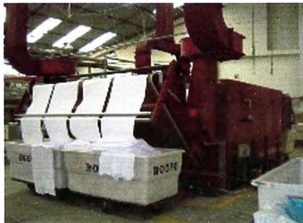
**Secadora de planta:** Operando a una temperatura entre  $120^{\circ}\text{C}$  –  $150^{\circ}\text{C}$  la tela pasa a través de una banda sin fin dentro de la secadora que demora entre un minuto a 45 seg. en devolver la tela ya seca, en la figura se observa como sale la tela seca.
