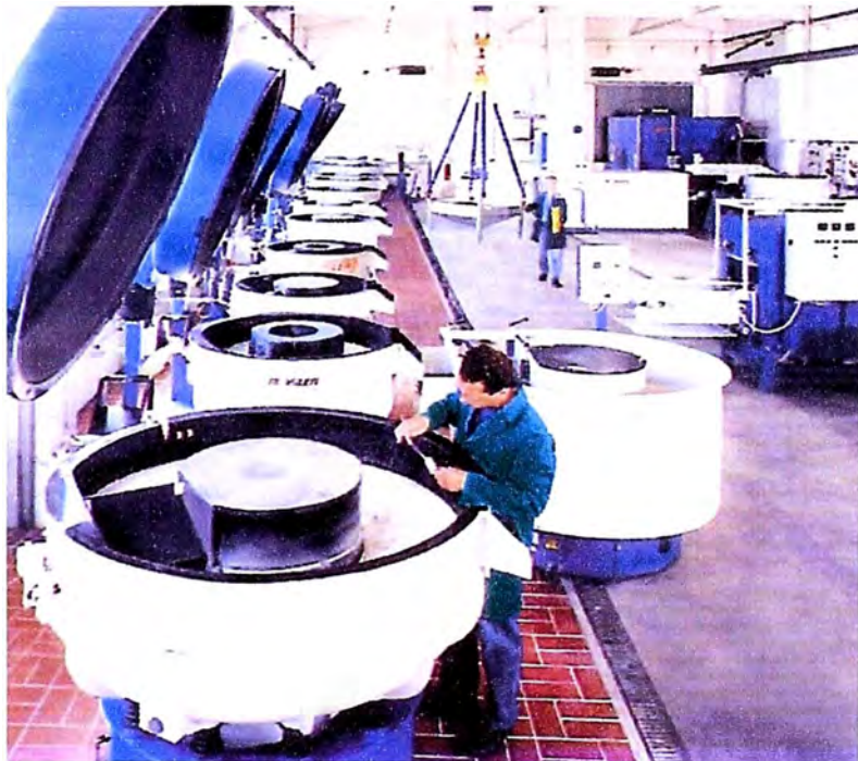
Fig. 6.9 Equipos de vibrado.
