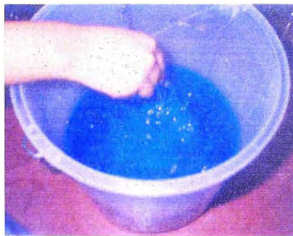
Foto N.13.- Al agregar los 3,7143L de solución de hidróxido de sodio se produce la formación del precipitado de hidróxido cúprico. Se puede apreciar que sin proporcionar calor al sistema no se produce la reducción.
