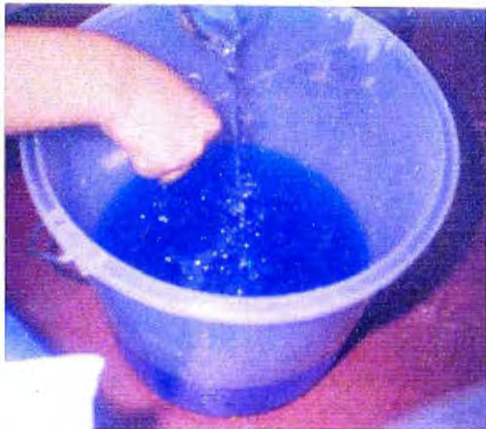
Foto N.12.- Se agregan a los 5L de solución de sulfato de cobre pentahidratado 1,3215L de solución de glucosa monohidratada.
