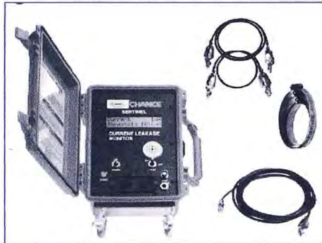
Figura 6.15 Equipo detector de corriente de fuga para equipos de trabajo aislados.
