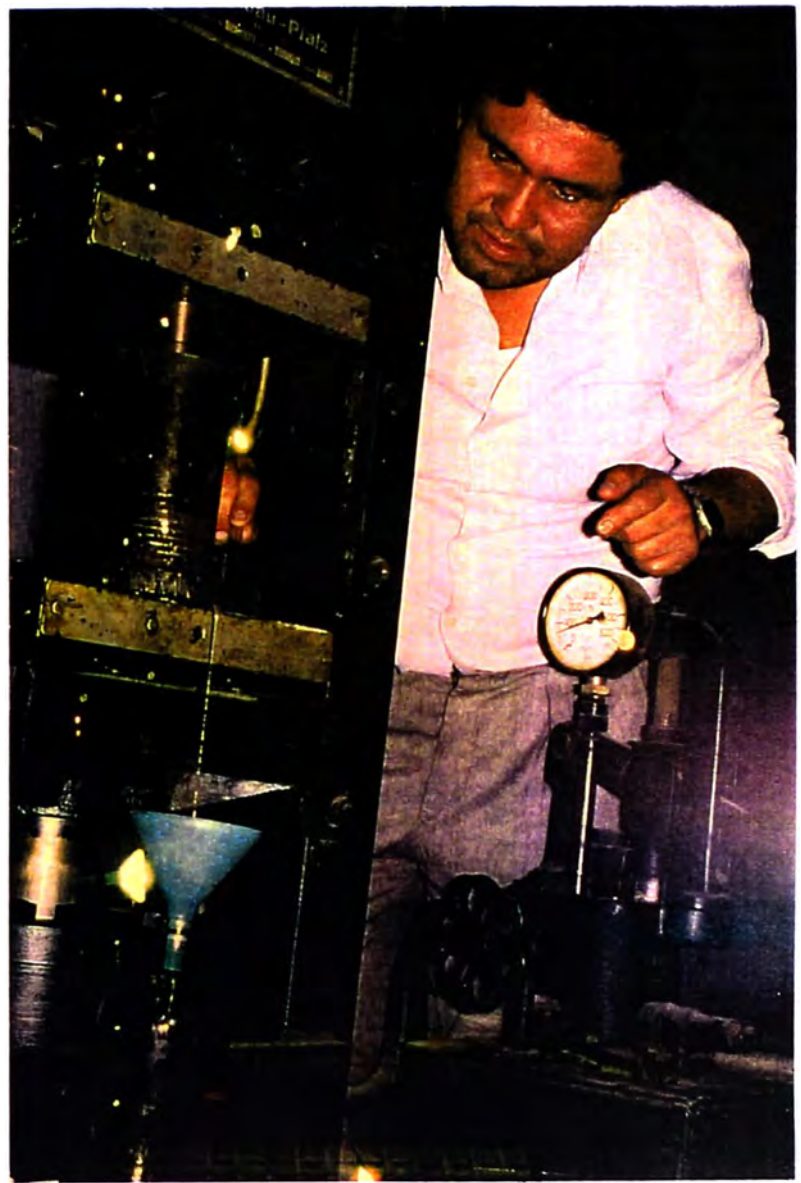
Frensado de semillas de Higuierilla para obtener Aceite de Ricino Fig. 13
