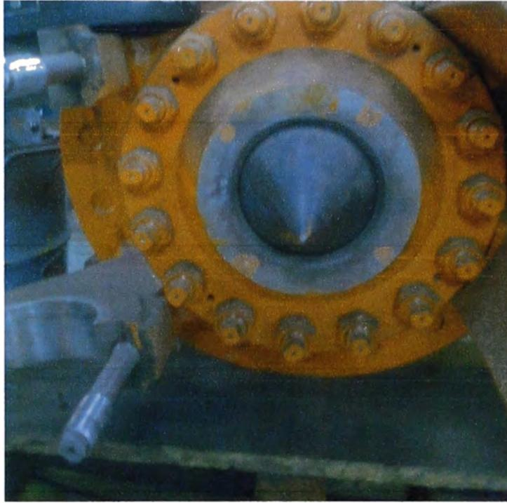
**Figura 1.3:** Inyector de la central hidroeléctrica Charcani V
