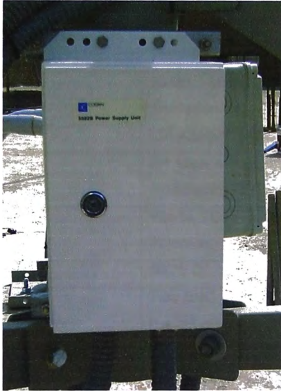
Figura 3.9 Fuente de alimentación CODAN 5582B (Fuente: Propia)
