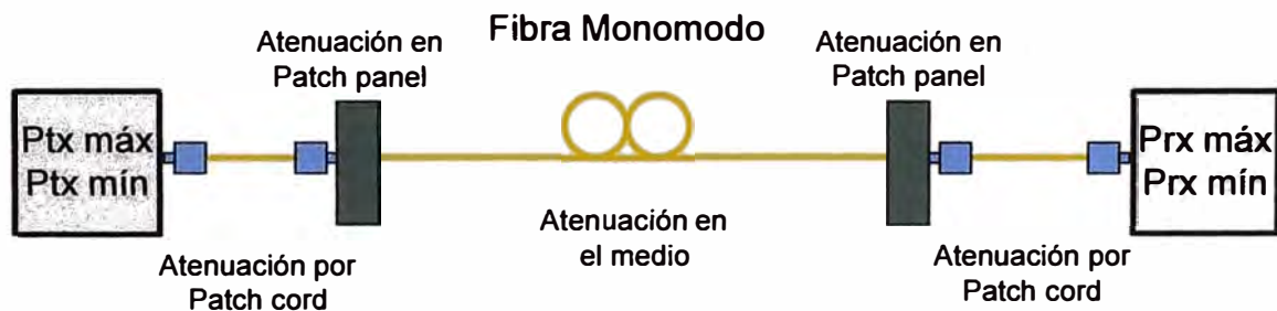
Figura 3.19 Enlace por fibra óptica (Fuente: Propia)
