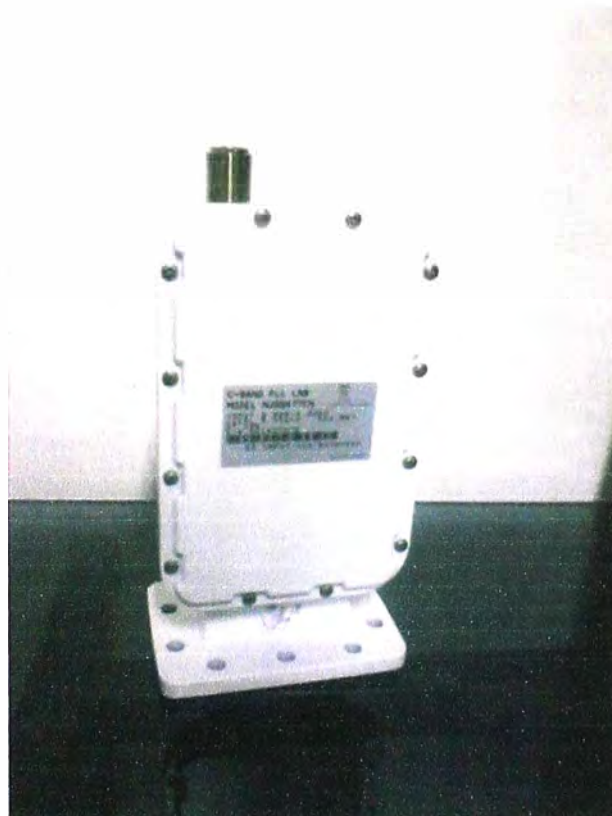
Figura 3.17 LNB JRC NJS8477EN (Fuente: Propia)
