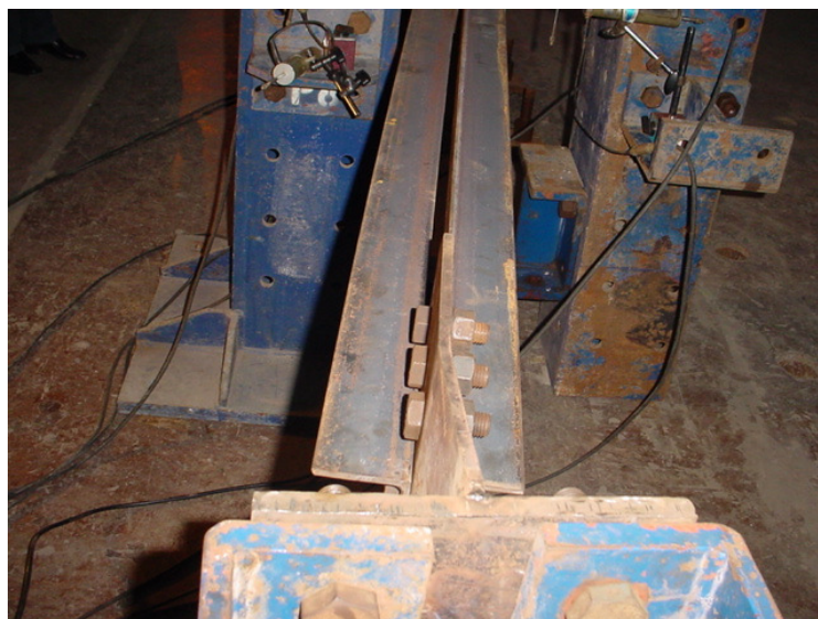
Foto 4.2: Pandeo de la Plancha soporte del puntal
