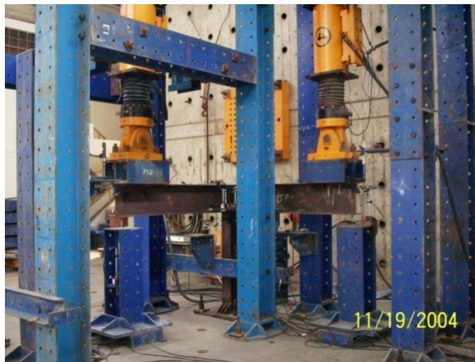
Foto 4.7: Ensayo de Conexión Viga Columna con vigas en voladizo
