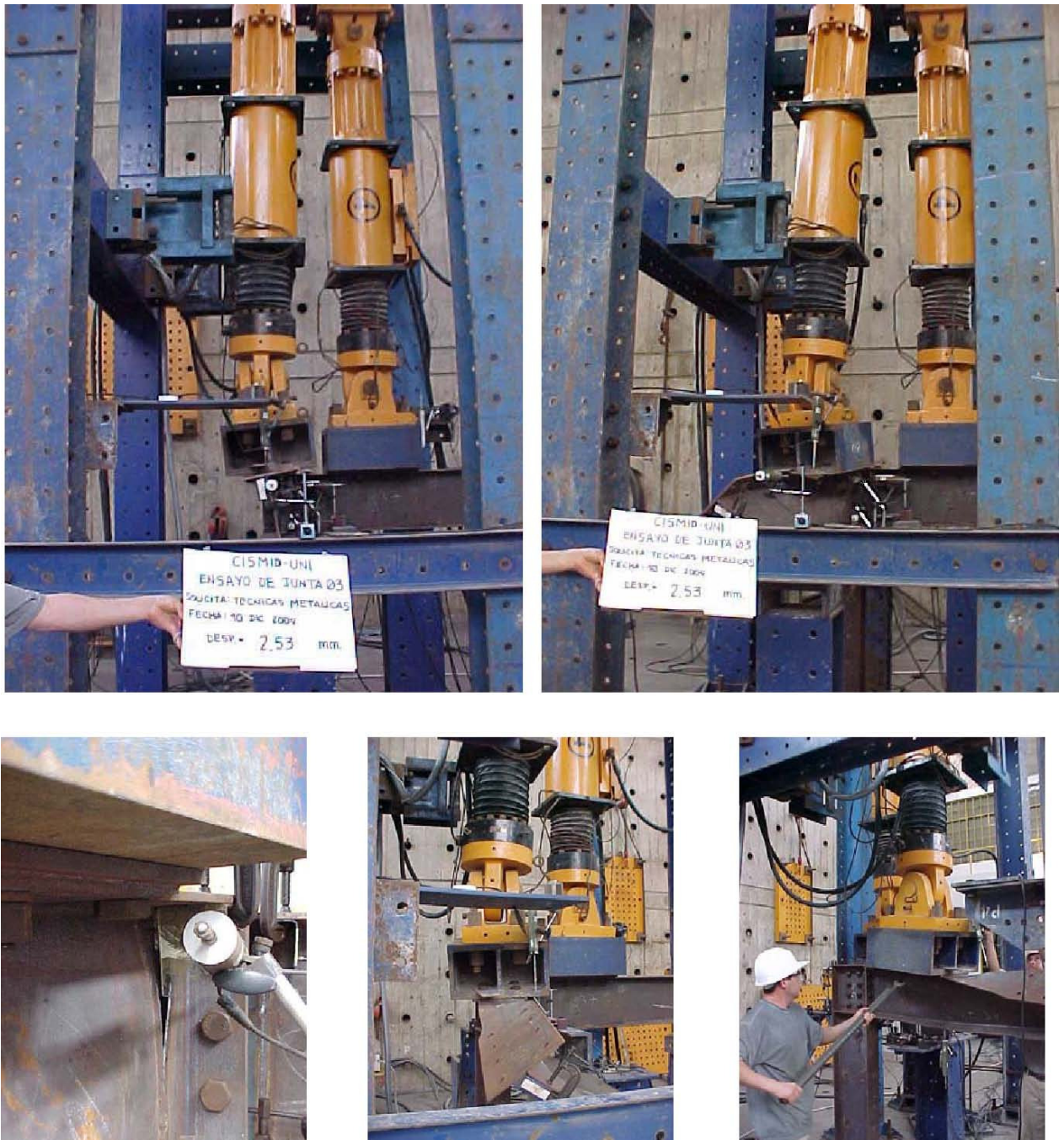
Foto 4.12: Ensayo Junta 2, Viga IN35
