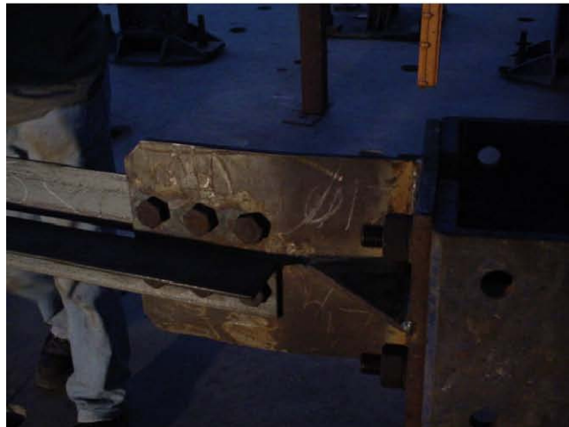
Foto 4.6: Detalles, ensayo Arriostre XL16
