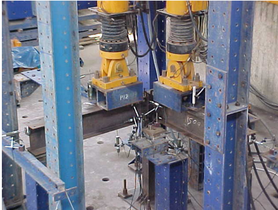
Foto 4.8: Ensayo de Conexión Viga Columna con vigas apoyadas
