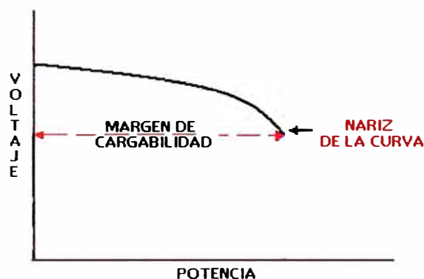
Fig. 1.13 Margen de cargabilidad en la curva PV
