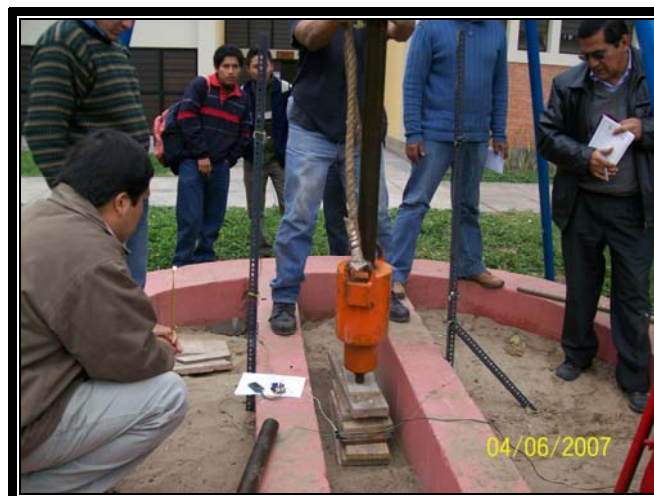
Foto N° 2.1.9 Se observa los emisores y receptores instalados en dos vigas acaneladas verticales y el descanso del martillo y base (anvil) sobre tablas.
