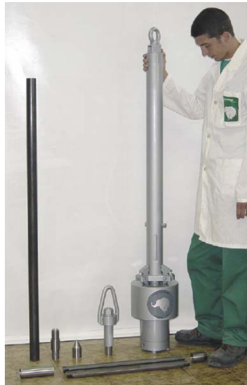
Foto N°. 2.1.1 Dispositivo automático de caída del martillo
