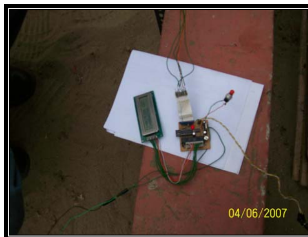
Foto N° 2.1.8 Detalle del Microcontrolador empleado para la lectura de los tiempos
