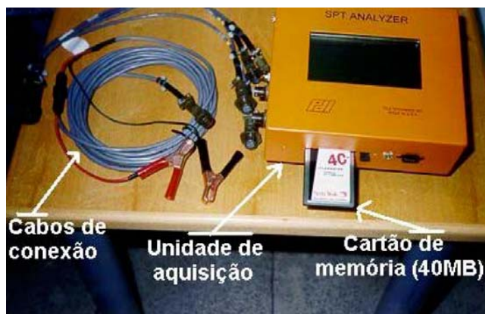
Foto N° 2.1.4 Equipo Analizador SPT. Unidad de adquisición de datos.
