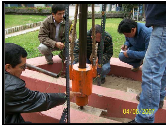
Foto N° 2.1.10 Se señala la marca del emisor 3 en el martillo.
