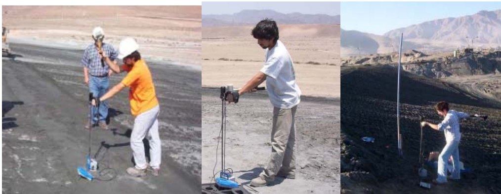
Foto N° 2.7.1 Equipo PANDA en operación
