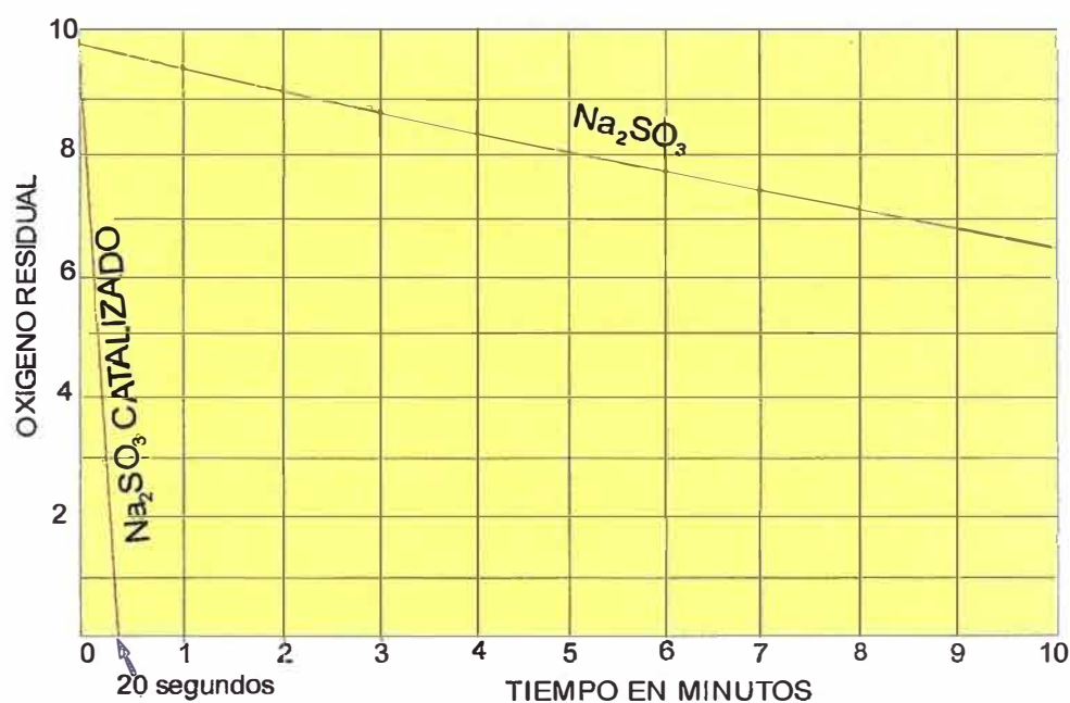
Figura N° 5.38: comportamiento del sulfito de sodio con y sin catalizador (Fuente: Tratamiento de aguas industriales. F. Vergara Yayón)
