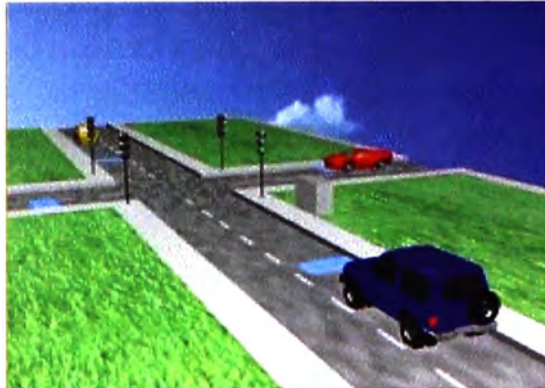
Ilustración 6-4 Sensores en el pavimento
