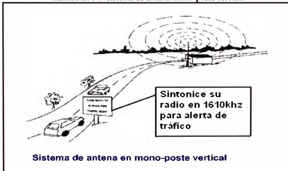
Ilustración 3-3 Sistema de antena mono-poste vertical
