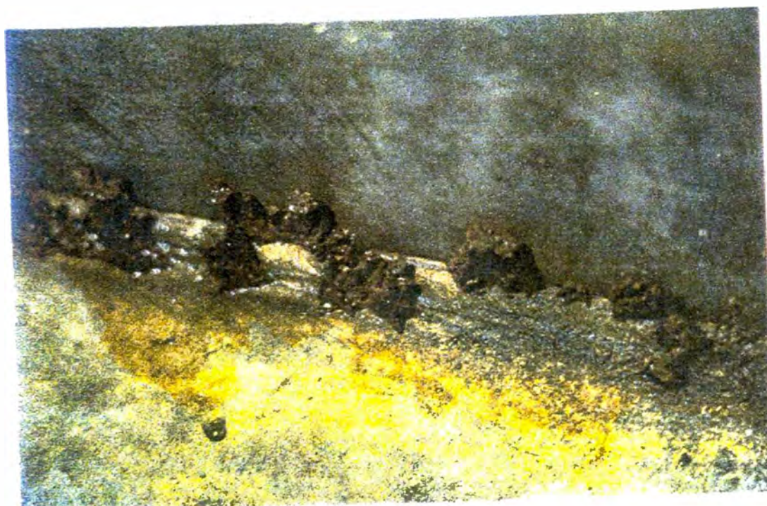
Foto N° 2A.- Ac. Inox. 316 con depósitos de MIC.
