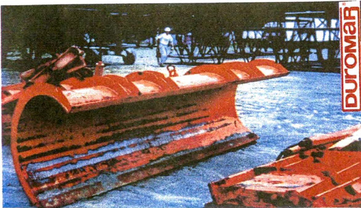
Foto N° 9A.- Cuchilla de Recogedor de nieve con falla en el recubrimiento de uretano.
