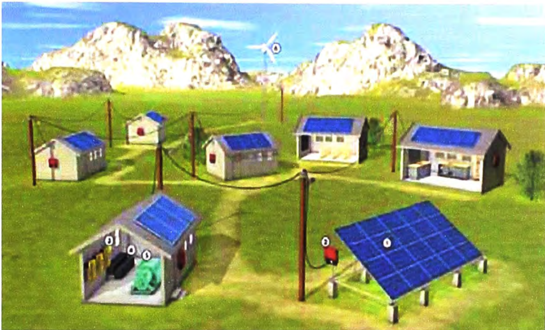
Fig. 7.2: Ejemplo de una microrred rural aislada, Fuente: [14]
