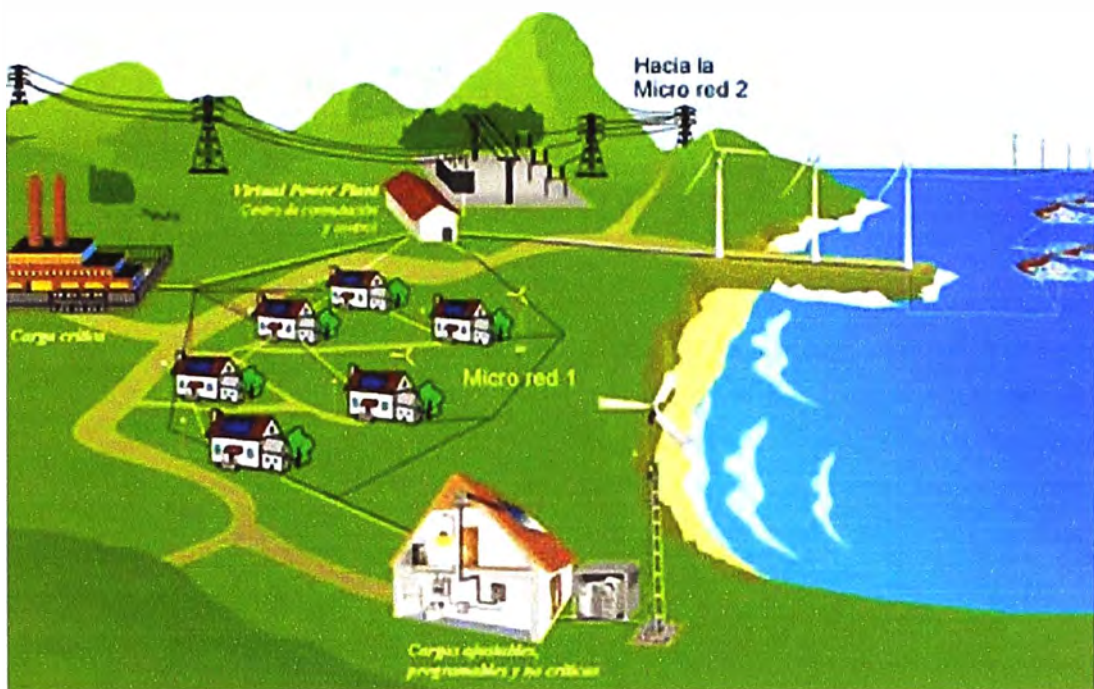
Fig. 2.1: Ejemplo de microrred en un sistema eléctrico (Fuente: Smart Grids-European Technology Platform)
