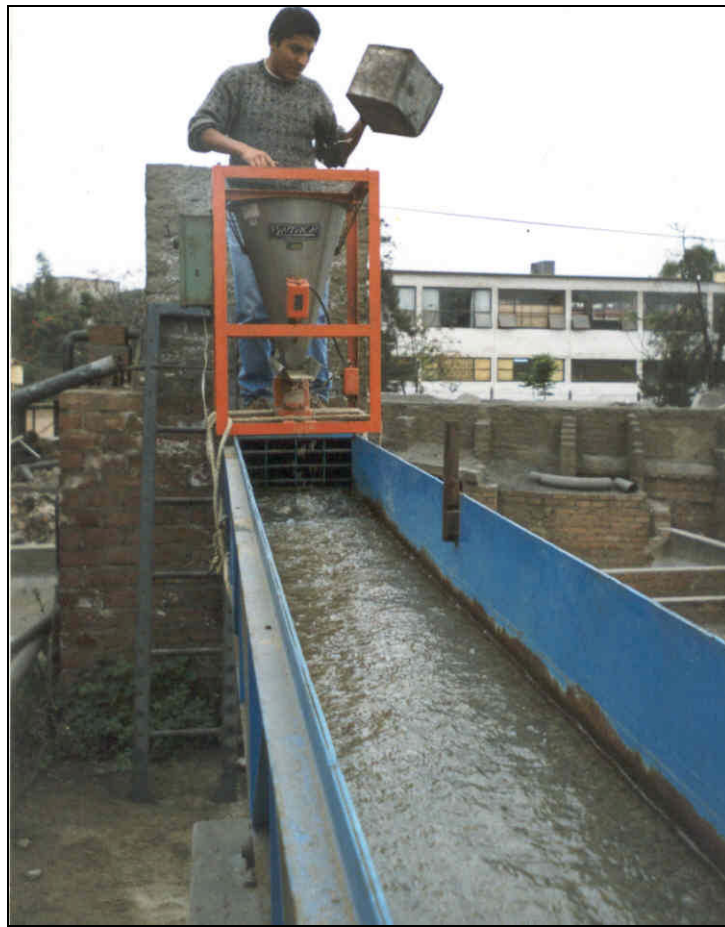
Fotografía 4.3 Vista del equipo experimental empleado para incorporación de sedimentos
