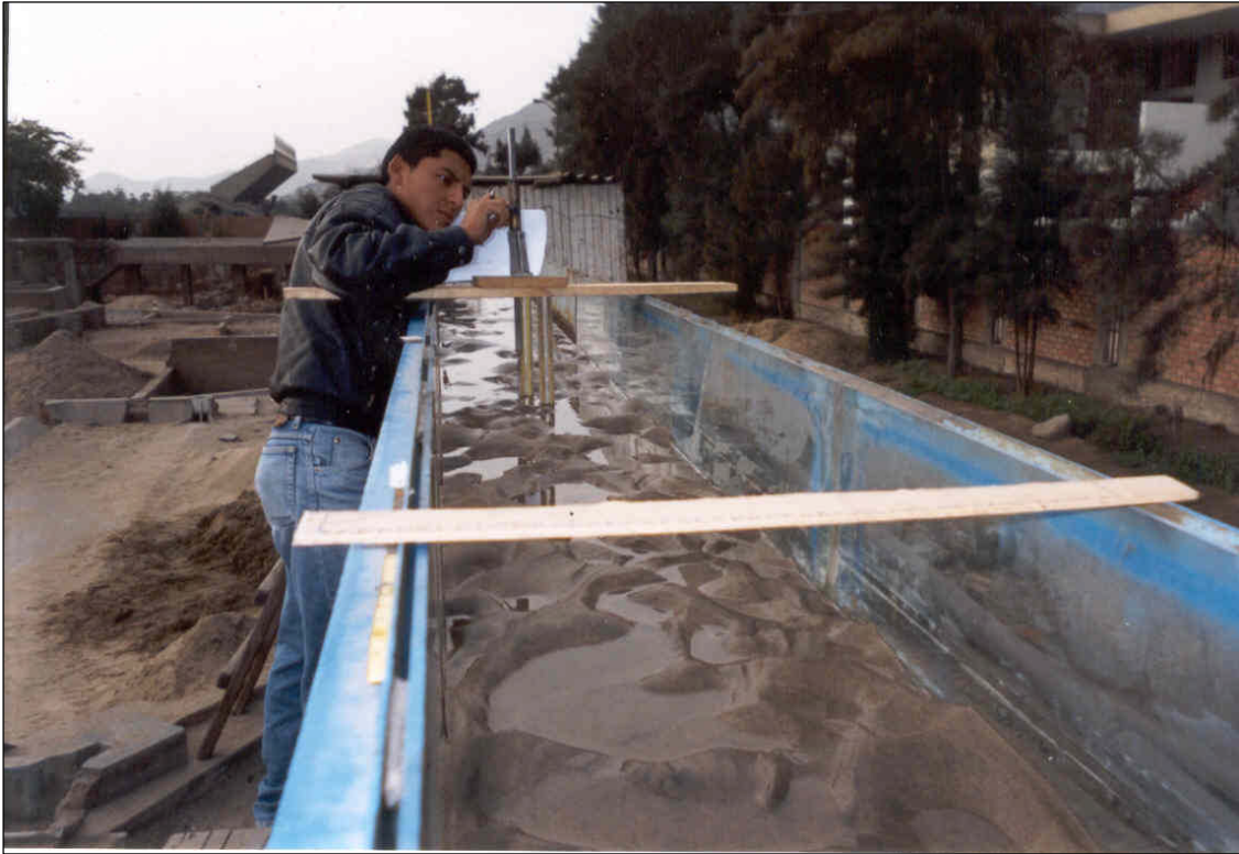
Fotografía 4.4 Vista del equipamiento experimental para la medición de la batimetría
