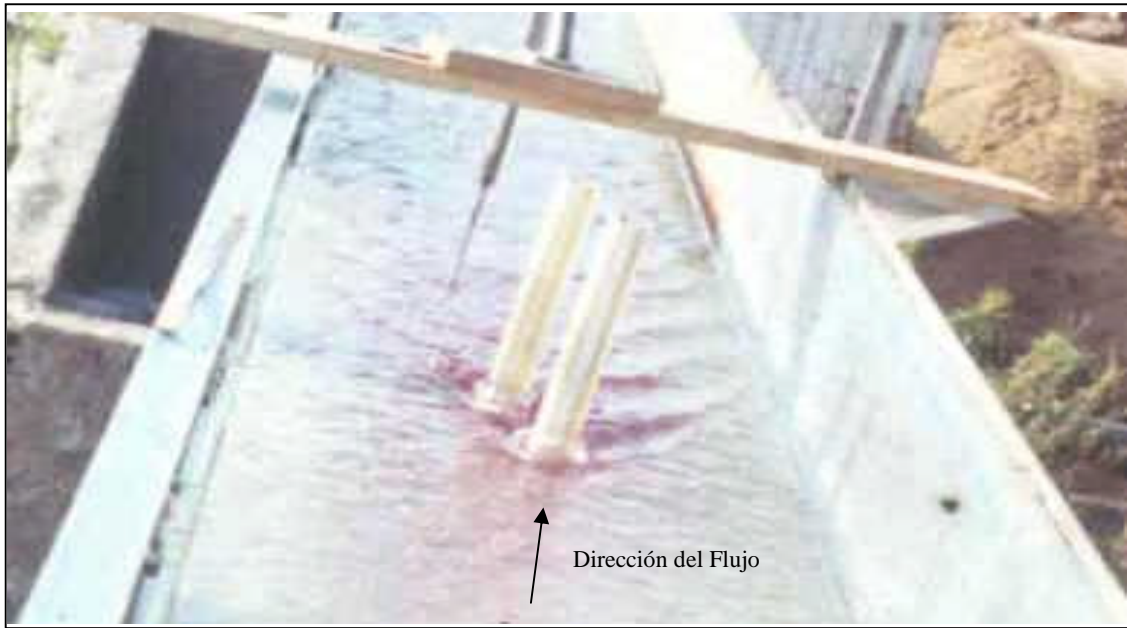
Fotografía 5.1 Formación de ondas a ambos lados del pilar en el flujo supercrítico.
