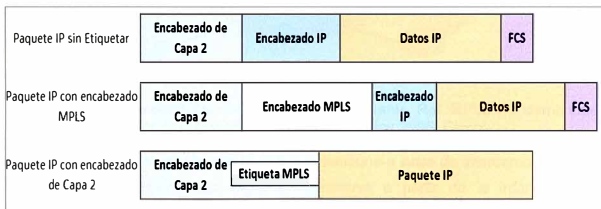
Figura 2.10 Implementación de Etiqueta MPLS (Fuente: Ref. MPLS Fundamentals: Autor: Luc De Ghein, Publicado 21 Nov 2006, Cisco)
