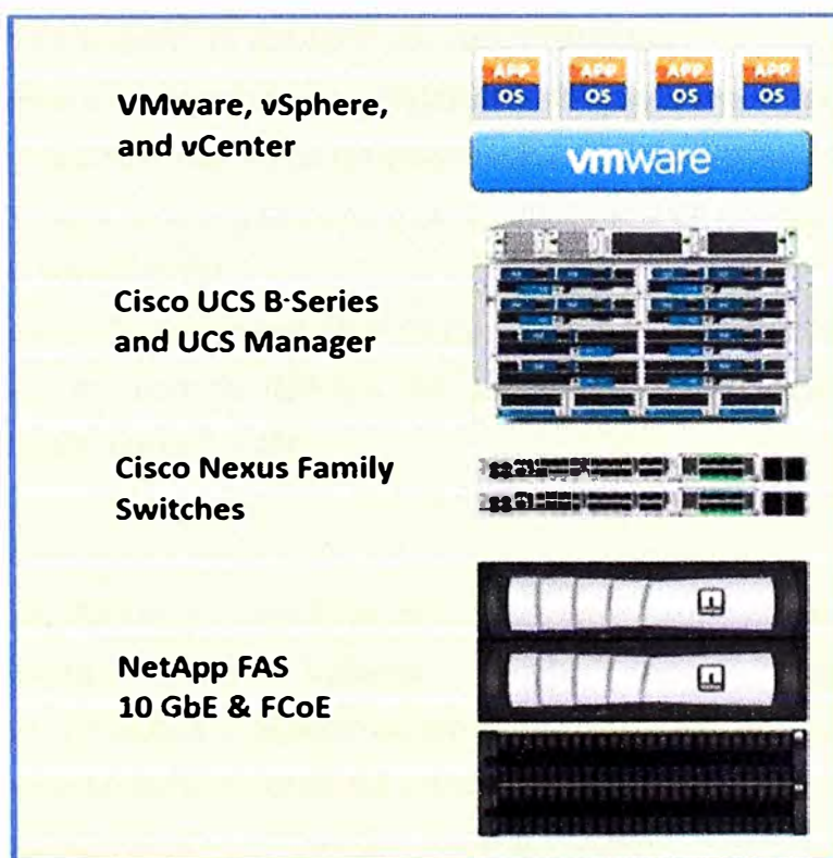
Figura 2.19 VMware con la solución Flexpod Datacenter (Fuente: Netapp-VMware) Elaboración: Editado de la fuente
