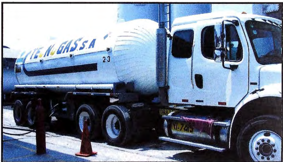
Cisterna para transportar CO 2 liquido hacia los clientes
