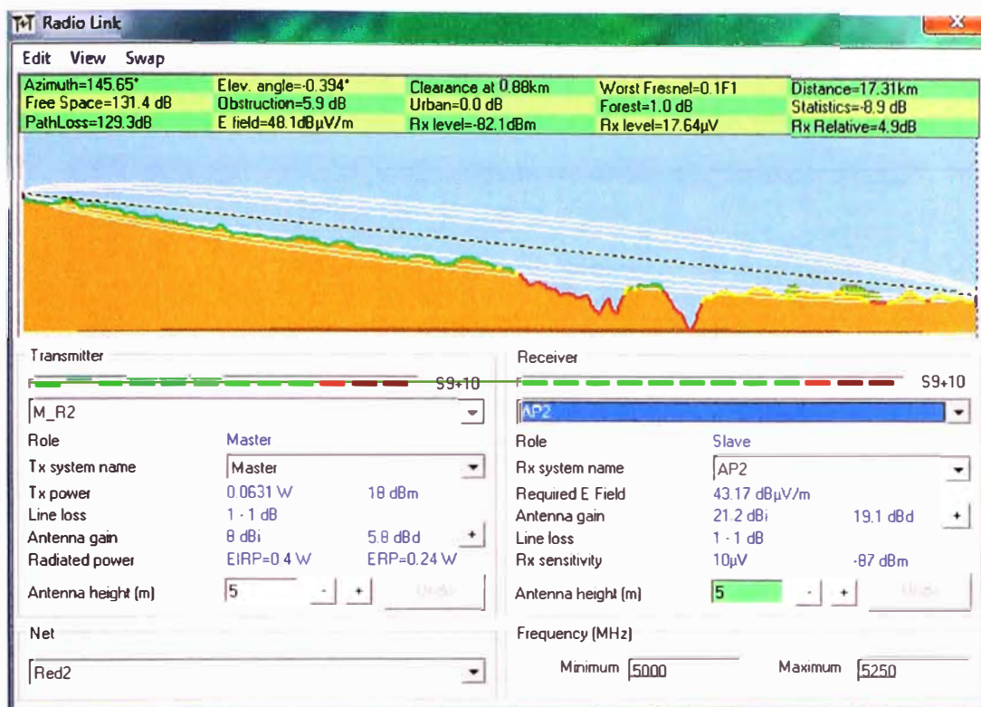
Figura 4.11 Simulación enlace Master – AP2
