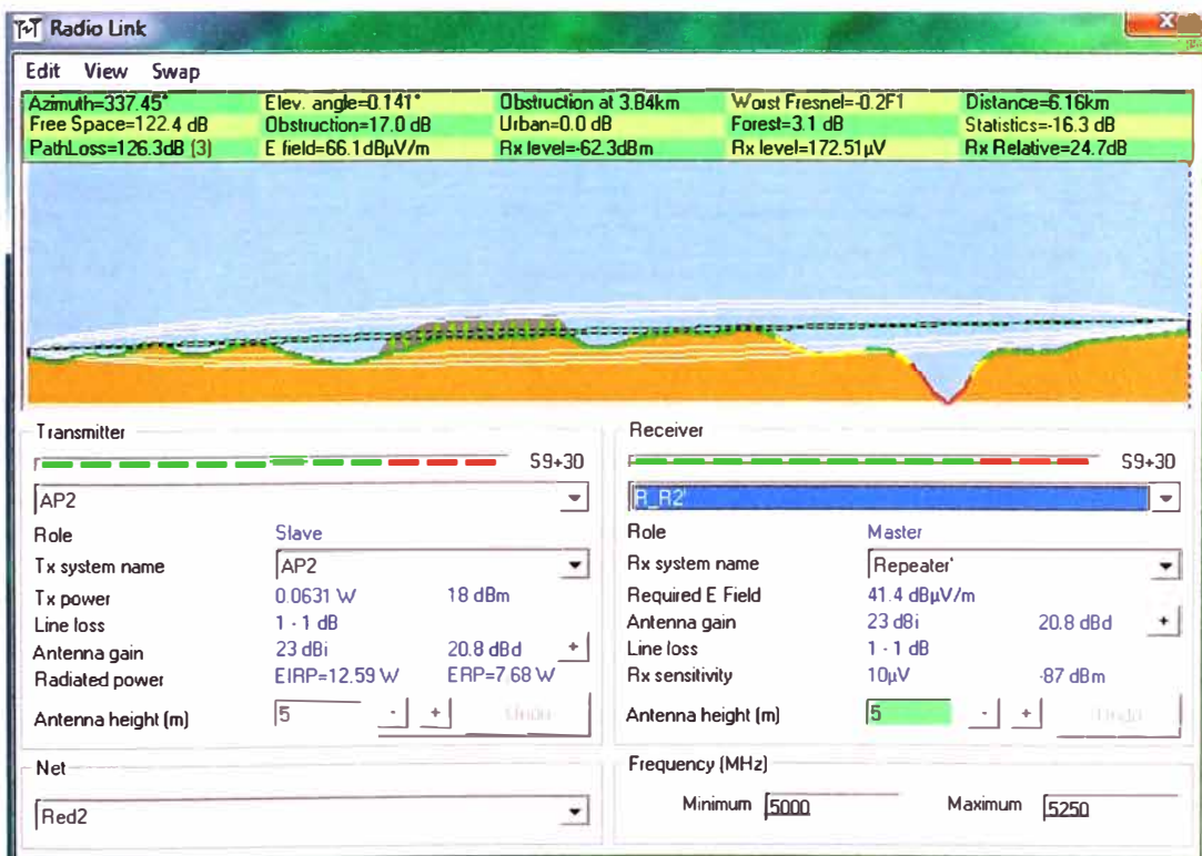
Figura 4.13 Simulación de enlace AP2 – Repeater'
