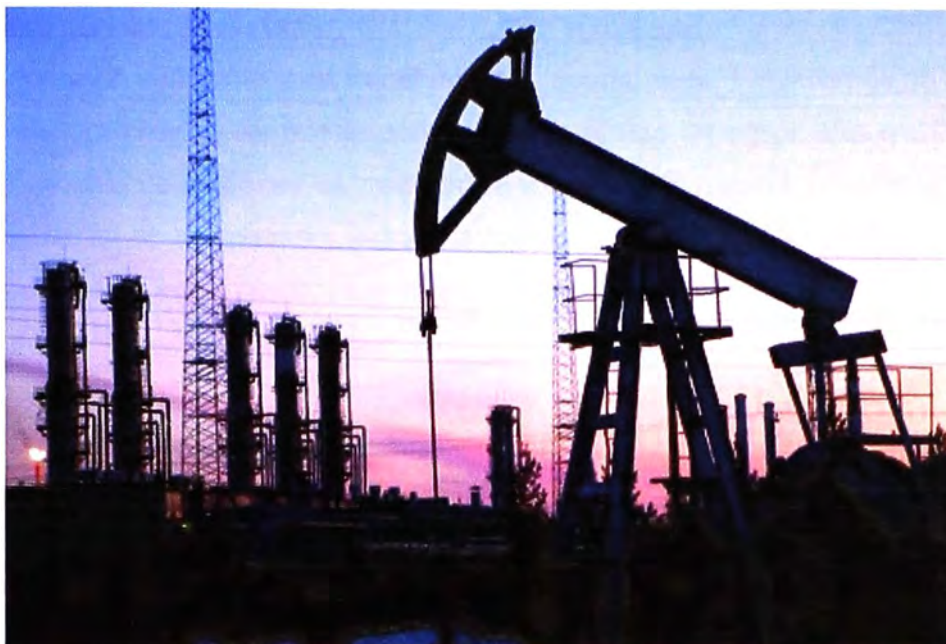
Figura 2.5 Bomba de varilla
