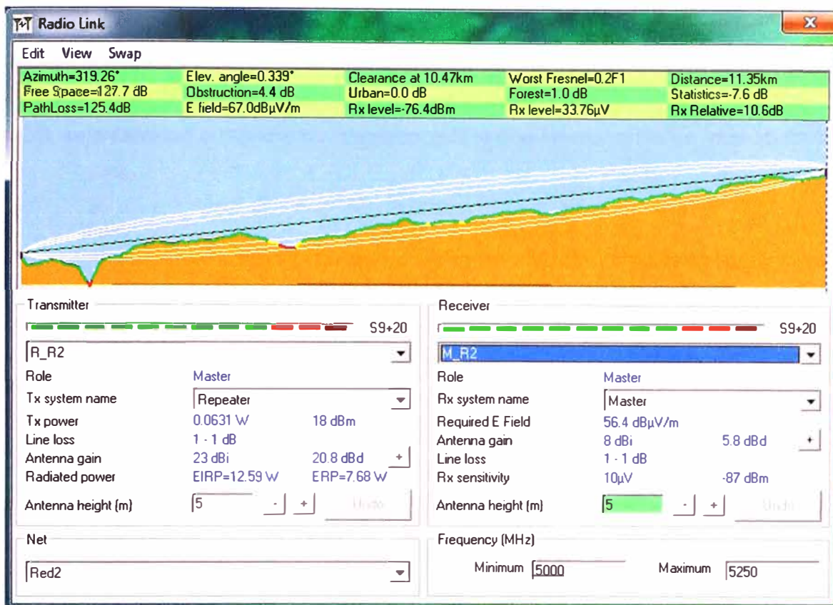
Figura 4.15 Simulación de enlace R_R2 - Master
