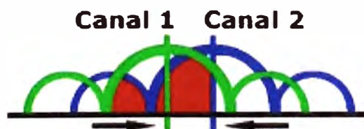
Figura 2.10 Interferencia entre canales contiguos
