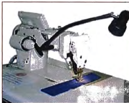
Figura N° 10: Alumbrado focalizado para operaciones especiales
