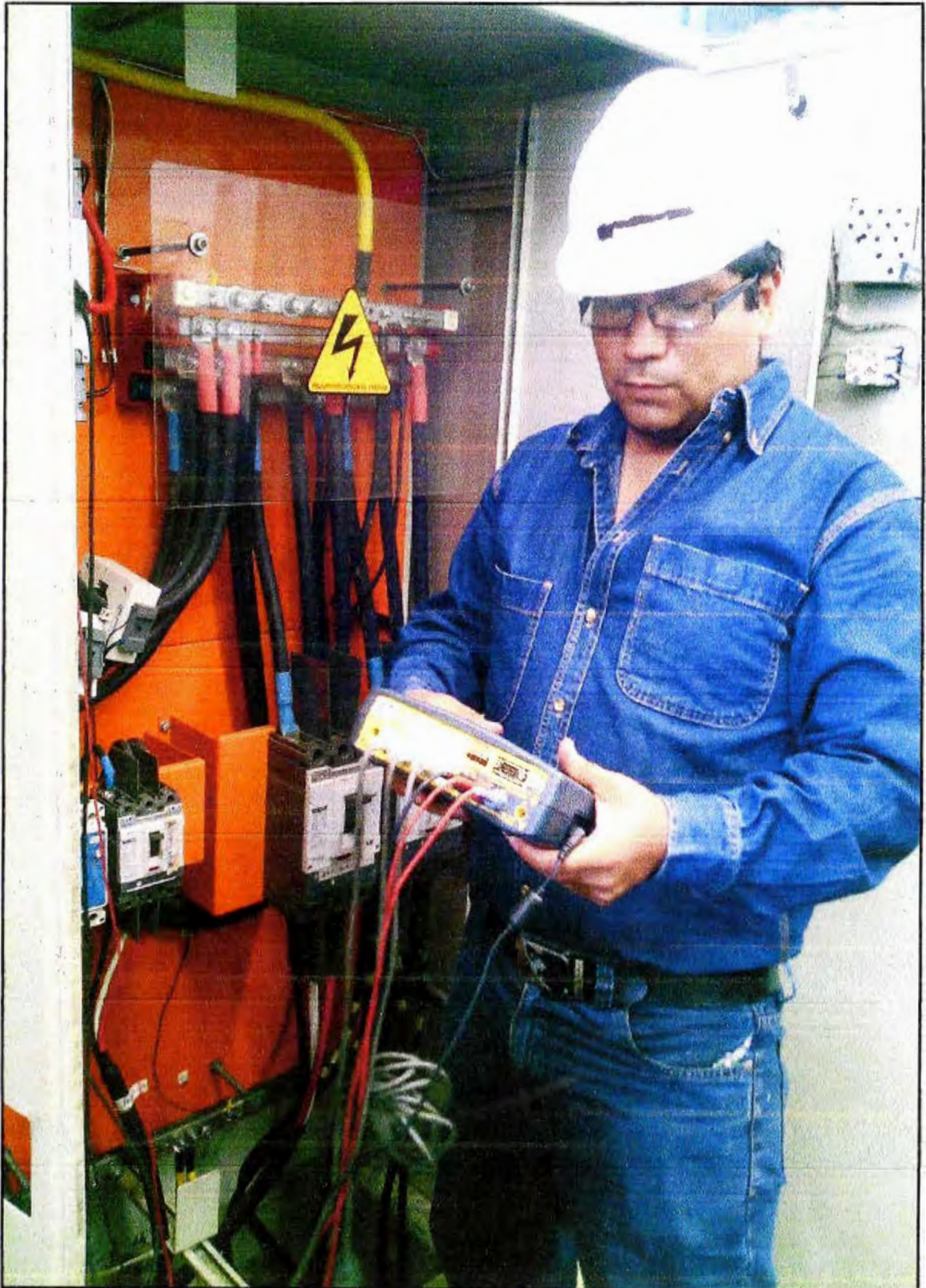
fig. 4.65 Configuración del analizador de redes, previo a la medición en el PCC.
