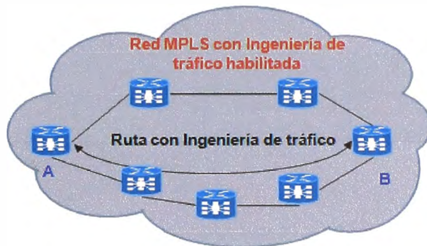
Fig. 2.10 Ingeniería de tráfico
