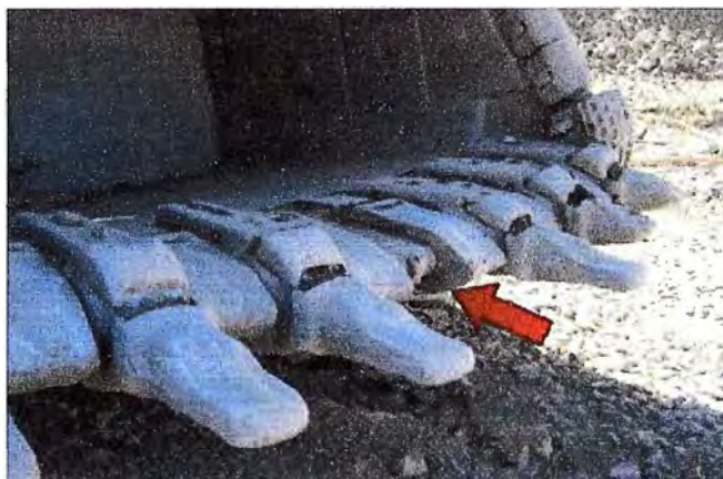
Figura 3.2 Detalle de balde con diente faltante en pala hidráulica (Fuente: Motion Metrics, [8])
