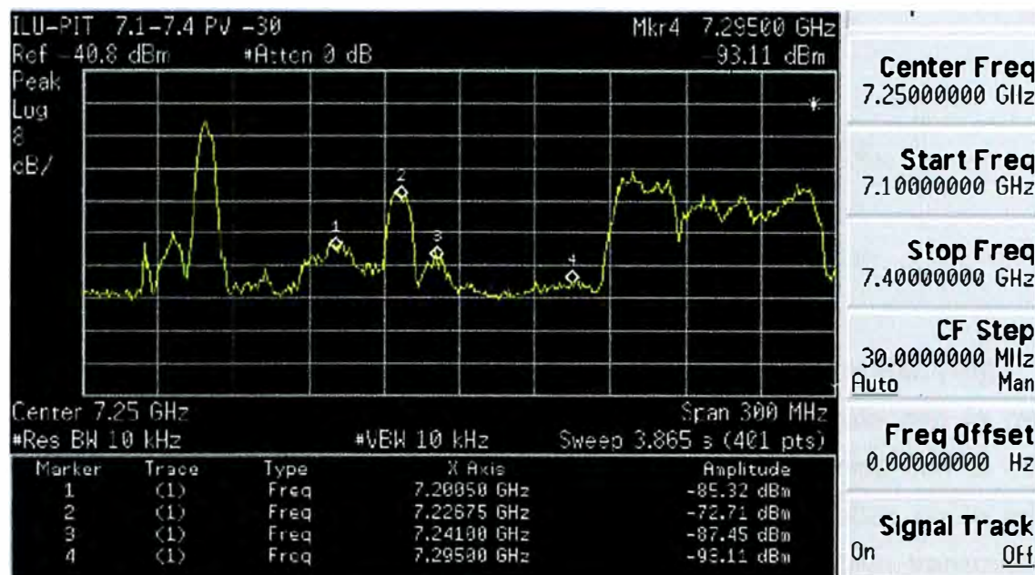
Figura 2.8 Barrido espectral en la banda de 7.1 a 7.4 GHz, donde se observa el uso desordenado de espectro (Fuente: Ref. [10])
