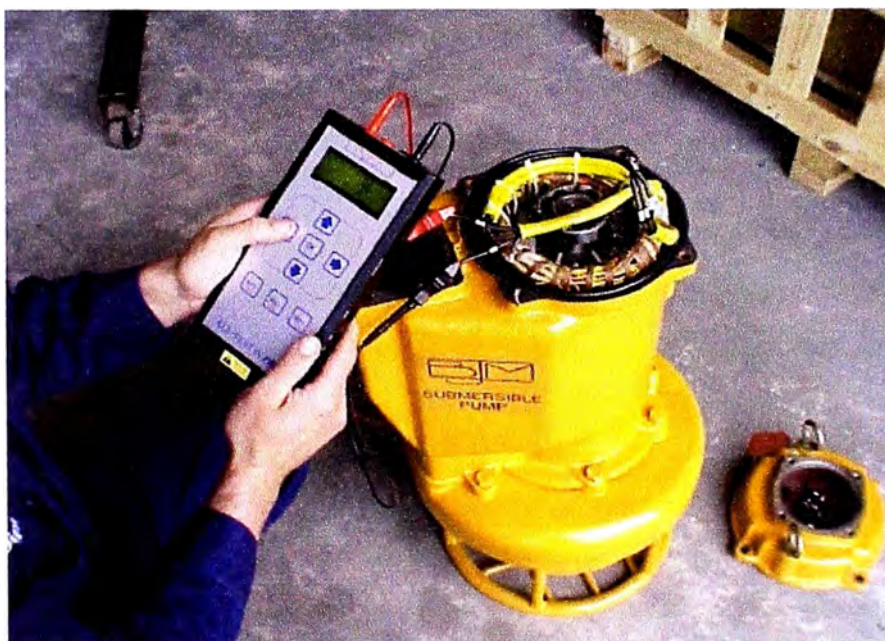
Figura 2.18 Pruebas estáticas de motor (Fuente: Referencia [34])
