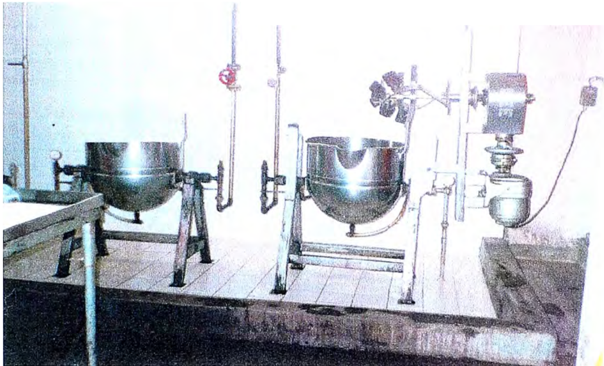
FOTO 4.3 EQUIPOS DE EXTRACCION USADO EN LA PRUEBA PILOTO
