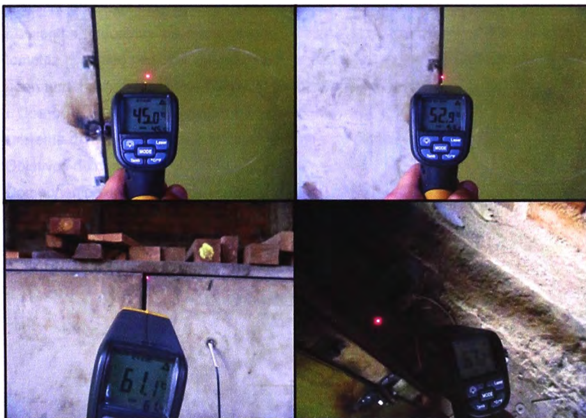
Figura 1.10 – Evaluación del aislamiento térmico (Horno a 80°C) Fuente: Elaboración Propia
