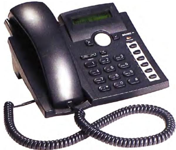
**Figura 2.16 Teléfono IP Snom-300**
