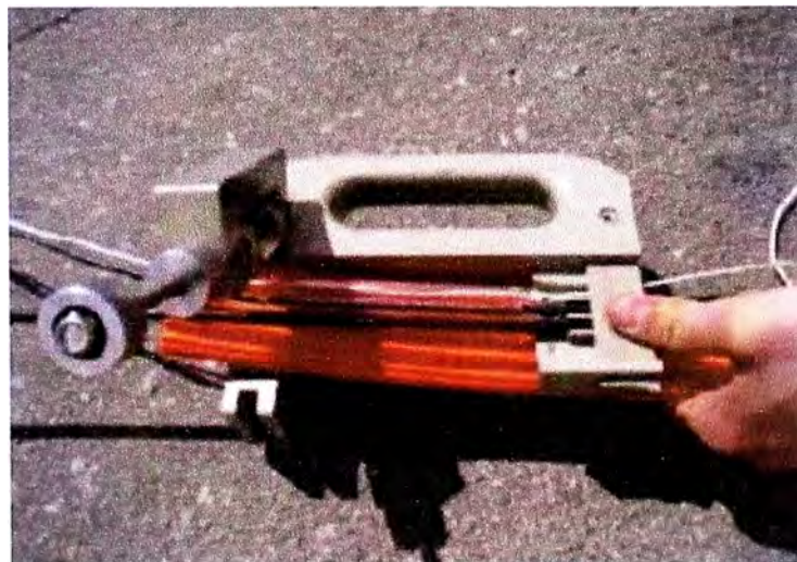
Figura 4.8 Colocación de la primera canaleta en la herramienta de ensamblaje (Fuente Ref. [5])
