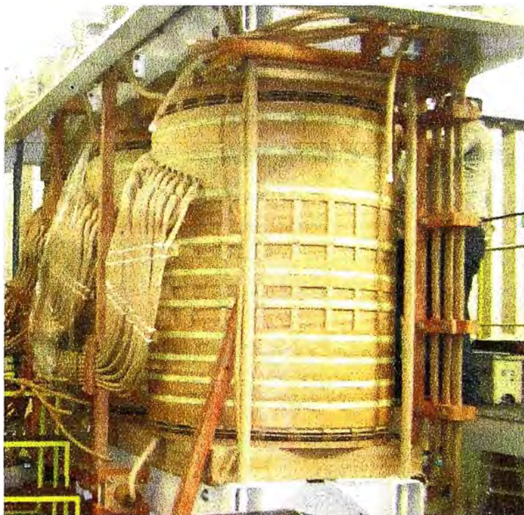
Figura 1.1 Bobinado y conexiones del transformador con material sólido aislante
