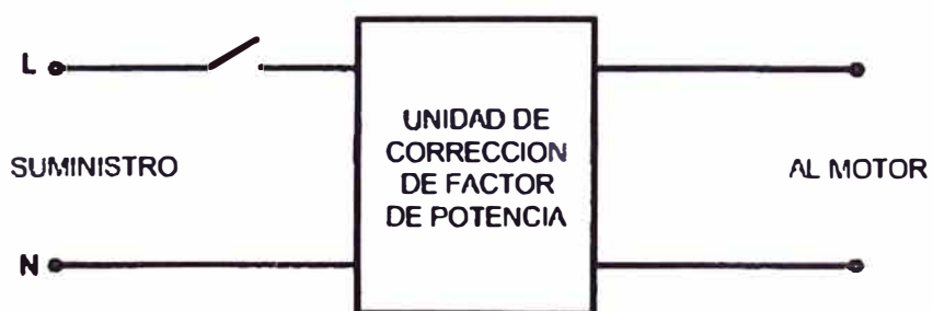
Figura A4.2: Conexión de la unidad de corrección del factor de potencia
