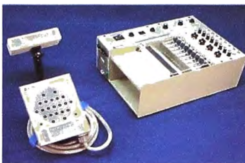
Fig.2.9 EEG Analógico con Cabezal y Fotoestimulador con lámpara Fuente: Akonic s.a. modelo Mini (Ítem 7)
