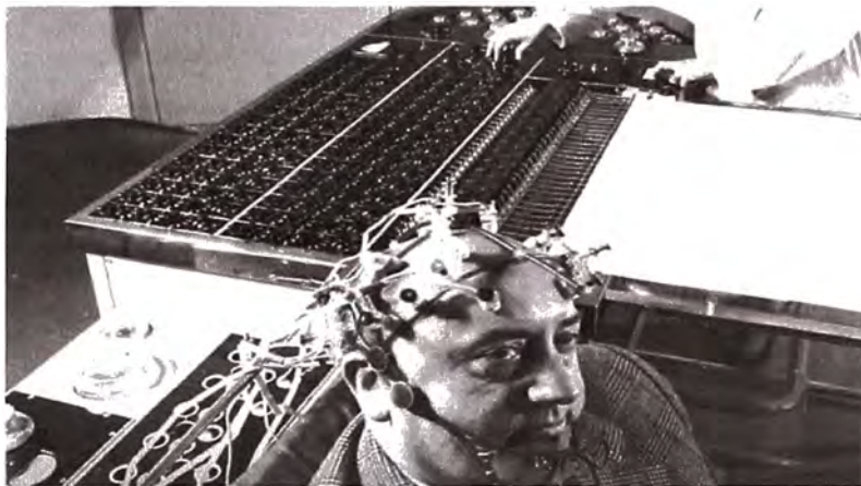
FIG. 2.6 Primer EEG Experimental a válvulas de 8 ampliado a 20 canales. Fuente: Mindmachines.htm (Ítem 5)
