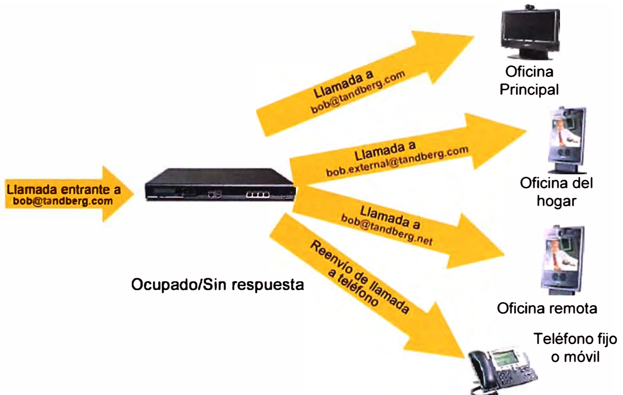
Figura 3.26 Esquema de funcionamiento de FindMe Tandberg
