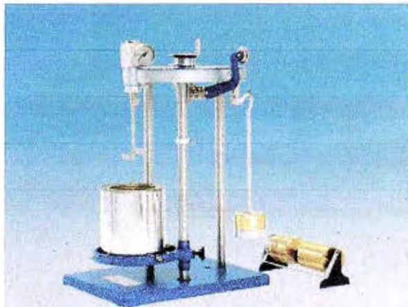
Figura 7.3: VISCOSÍMETRO STORNER CON ESTROBOSCOPIO
