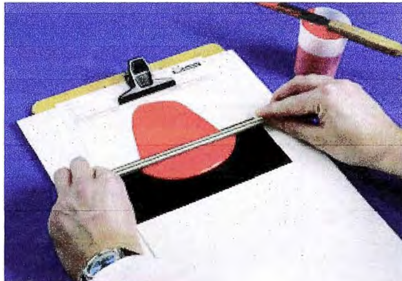
Figura 7.6: APLICACIÓN DE UNA PINTURA PARA MEDIR EL PODER CUBRIENTE
