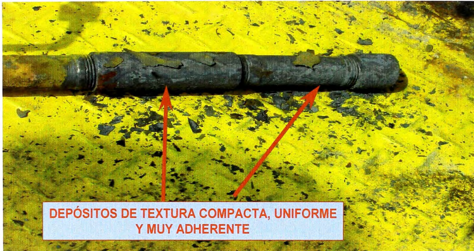
Fotografía N°20 : DEPÓSITOS ACUMULADOS SOBRE PROBETA DE CONTROL MANUAL EN HORNO F-1 - ETAPA SIN ADITIVO
