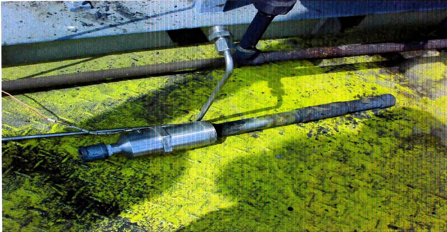
Fotografía N°19: RETIRO DE LA PROBETA DE CONTROL MANUAL DE ZONA CONVECTIVA HORNO F-1.
