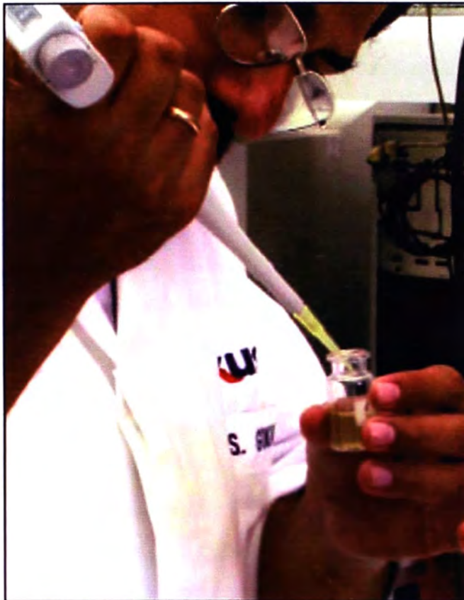
Fig. 24 Preparación de la muestra para cromatografía adición del estándar
