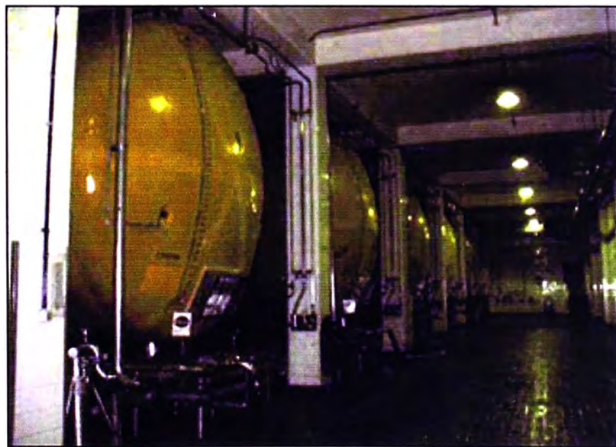
Fig. 14 Tanque de Cerveza Filtrada o Gobierno
