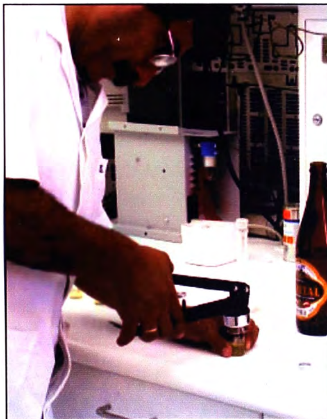
Fig. 25 Preparación de la muestra para cromatografía sellado de la viales
